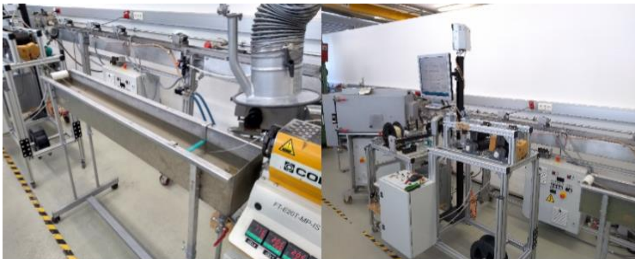
Slika 11: Jedinica za hlađenje i namotavanje filameta
