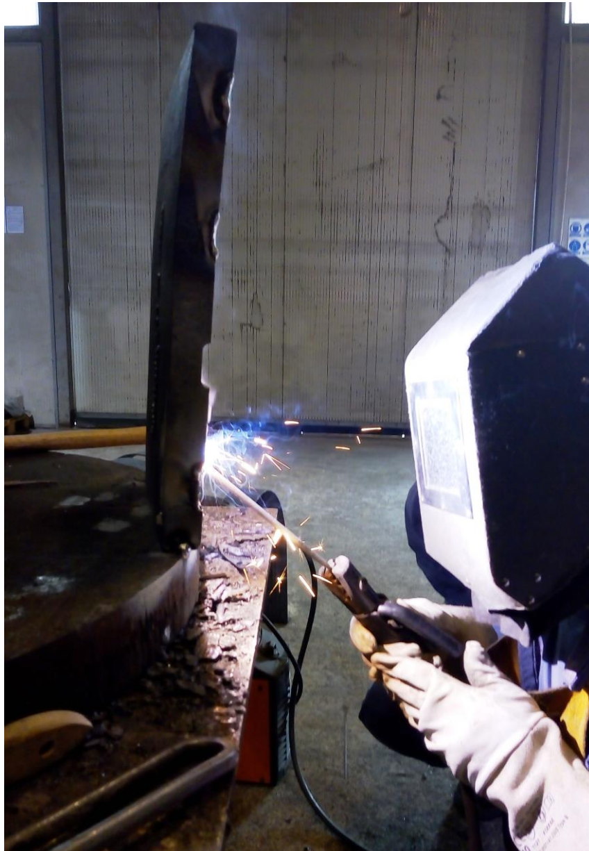
Slika 17 Navarivanje nodularnog lijeva REL postupkom
