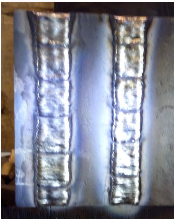
Slika 19 Navari zavareni REL postupkom
