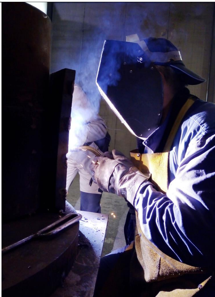
Slika 18 Navarivanje nodularnog lijeva PPŽ postupkom
