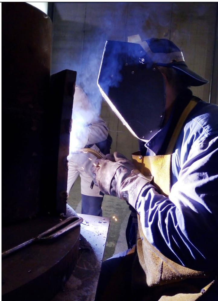
Slika 18 Navarivanje nodularnog lijeva PPŽ postupkom
