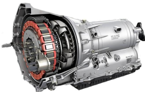
Slika 10 Jednodjelno kućište ZF 8HP mjenjačke kutije [4]
