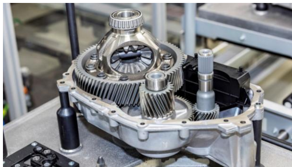
Slika 11 Dvodjelno kućište Volkswagenovog mjenjača s jednim stupnjem prijenosa [11]
