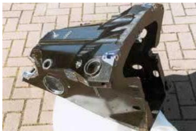
Slika 26 Kućiše od ugljičnih vlakana tima Arrows Formule 1, 1998. [29]
