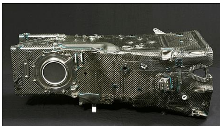
Slika 27 Audi LMP1 kućište mjenjačke kutije od ugljikovih vlakana. [30]
