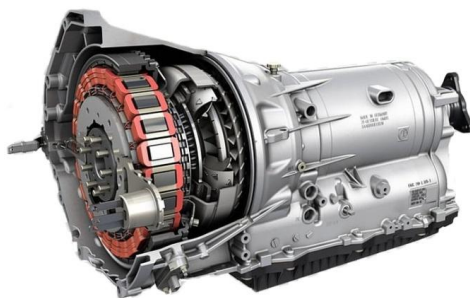
Slika 10 Jednodjelno kućište ZF 8HP mjenjačke kutije [4]
