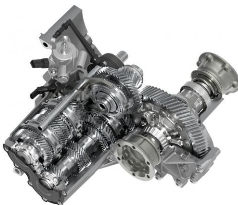
Slika 7 Volkswagenov ručni 6-brzinski mjenjač [6]
