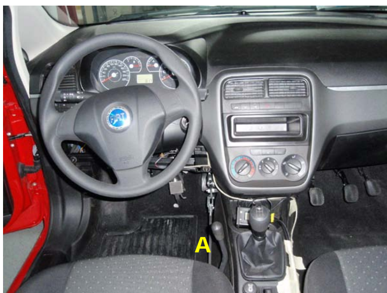
Slika 23. Smještaj poluge/ ručice (A) u kabini vozila
