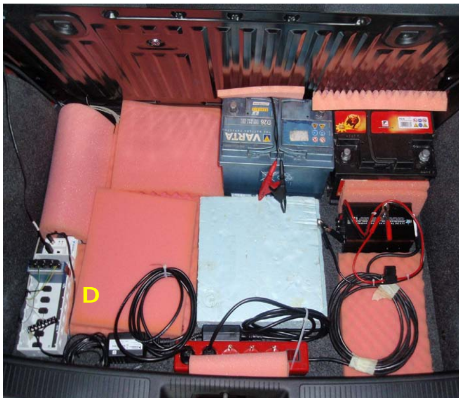
Slika 29. Pogled na opremu za kondicioniranje i prikupljanje podataka (D) smješten u prtljažni prostor vozila
