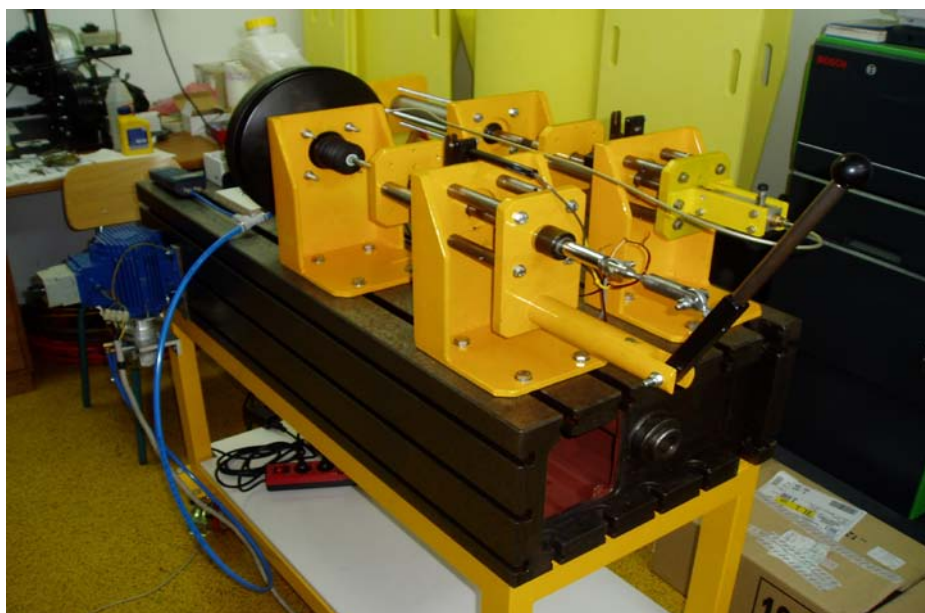
Slika 22. Mjerna linija - pogled sa strane ručice za zadavanje ulazne sile
