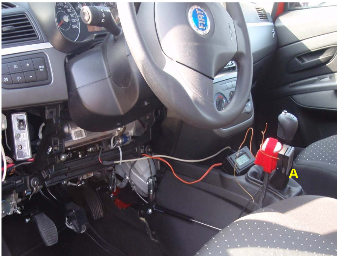
A - Senzor za mjerenje sile na ručicu uređaja
