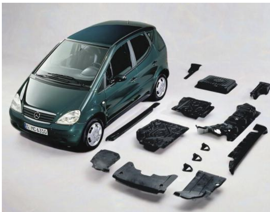
Slika 5.10 Donji dijelovi automobila ojačani lanenim vlaknima [28]
