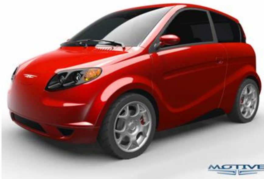
Slika 5.15. Električni automobil od biorazgradivog materijala na bazi konoplje [40]
