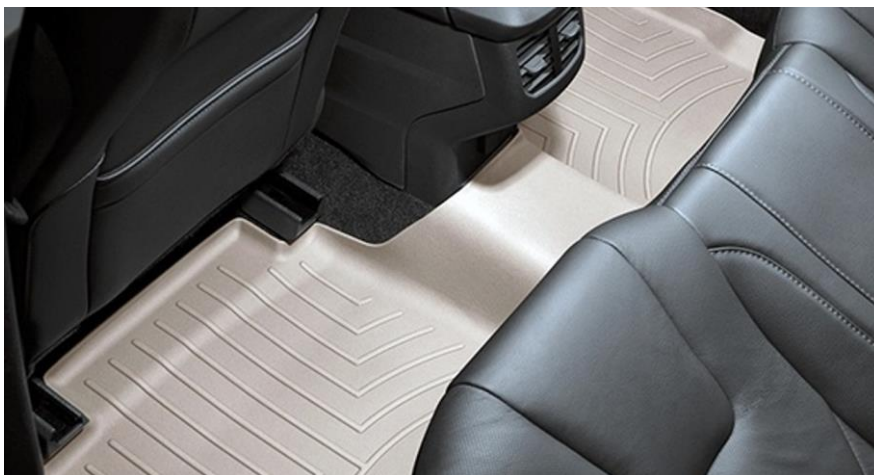
Slika 9.6. Tepih u automobilu Fordu Lincolnu od kompozita ojačanog vlaknima banane [76]
