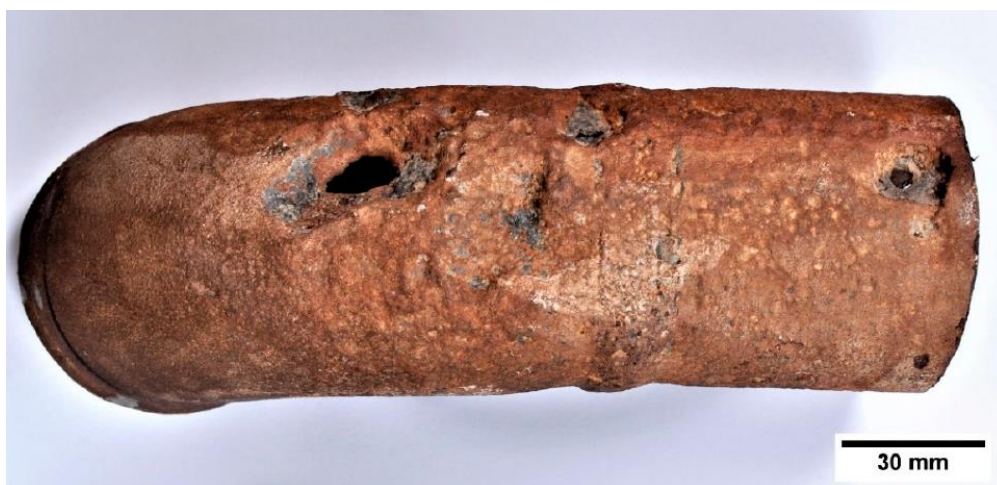
Slika 25. Oštećenje na cijevi nastalo nakon manje od 5 godina uporabe [32]
