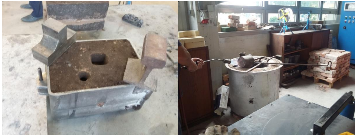
Slika 51. Kalup s utezima radi sprječavanja otvaranja tokom lijevanja i predgrijavanje lončića za za lijevanje
