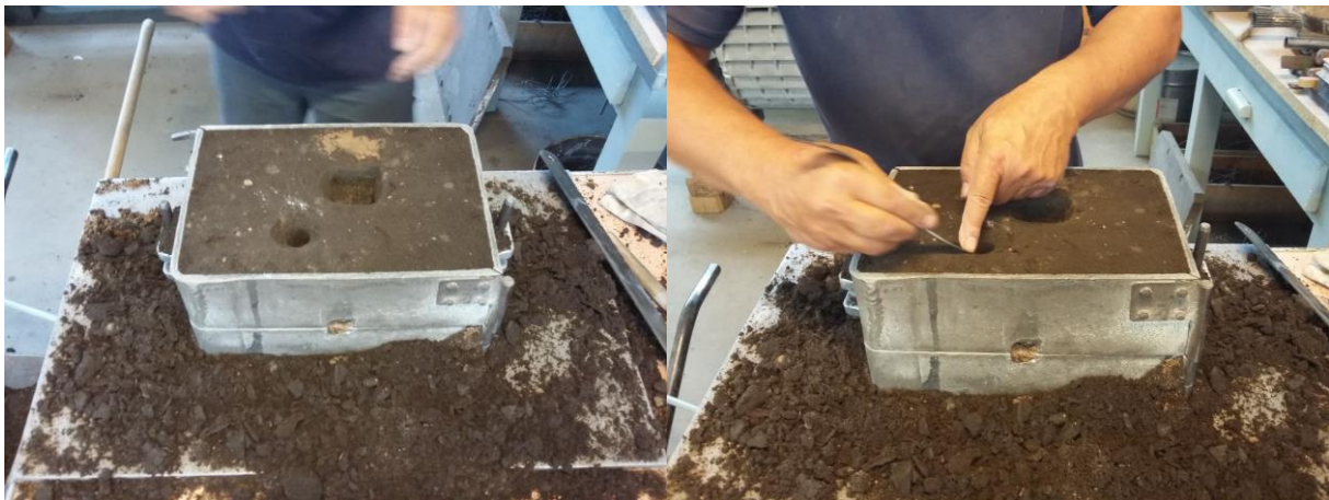
Slika 43. Zaobljenje oštih rubova uljevne čaše i pojila
