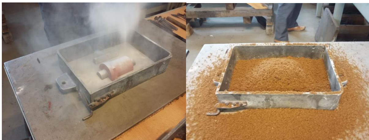
Slika 38. Zasipavanje donjaka prahom radi lakšeg vađenja modela i zasipavanje donjaka modelnom kalupnom mješavinom
