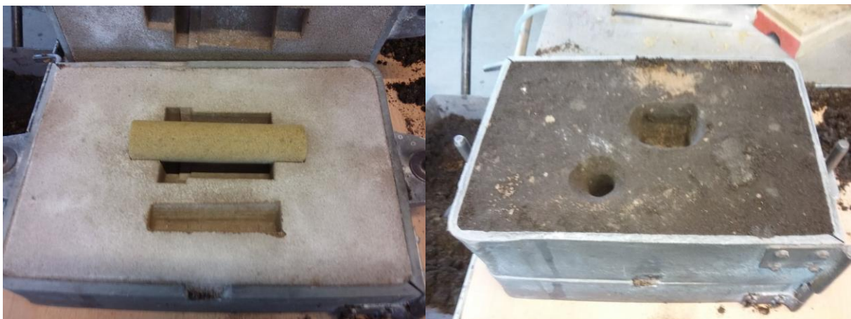
Slika 48. Umetanje jezgre u donjak i sklapanje kalupa
