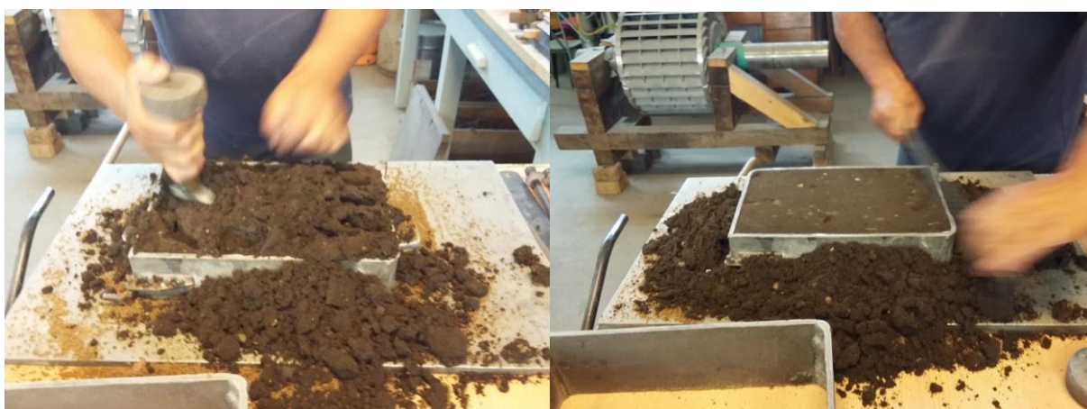
Slika 39. Dodavanje punidbene kalupne mješavine, njezino sabijanje i poravnavanje
