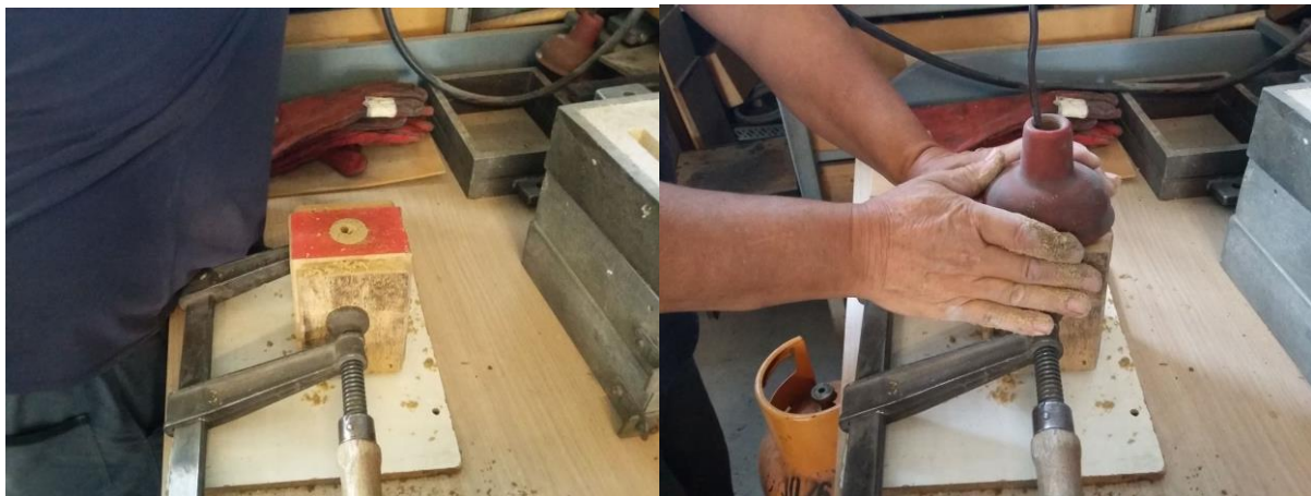
Slika 47. Propuhivanje jezgre plinom CO 2 radi očvrnuća
