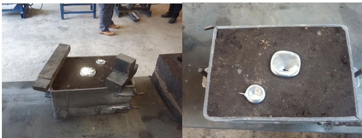
Slika 53. Skrućivanje metala u kalupu
