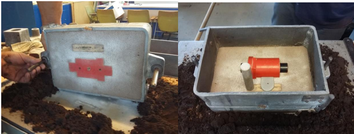
Slika 40. Model odljevka i razvodnik u donjaku i postavljanje modela u gornjak
