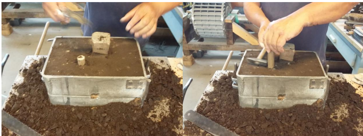
Slika 42. Poravnavanje kalupne mješavine i vađenje dijelova uljavnog sustava iz gornjaka
