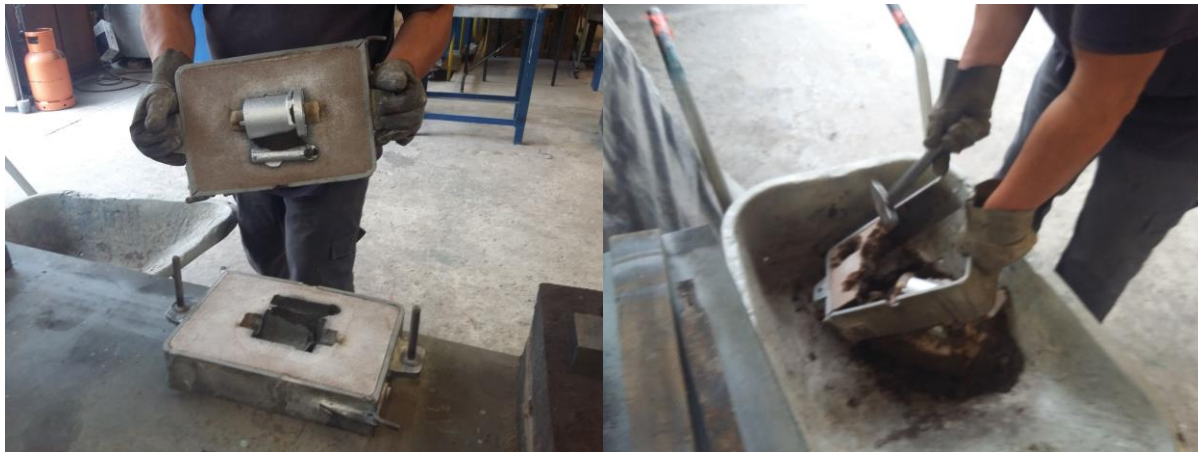
Slika 54. Razdvajanje gornjaka i donjaka te razrušivanje kalupa
