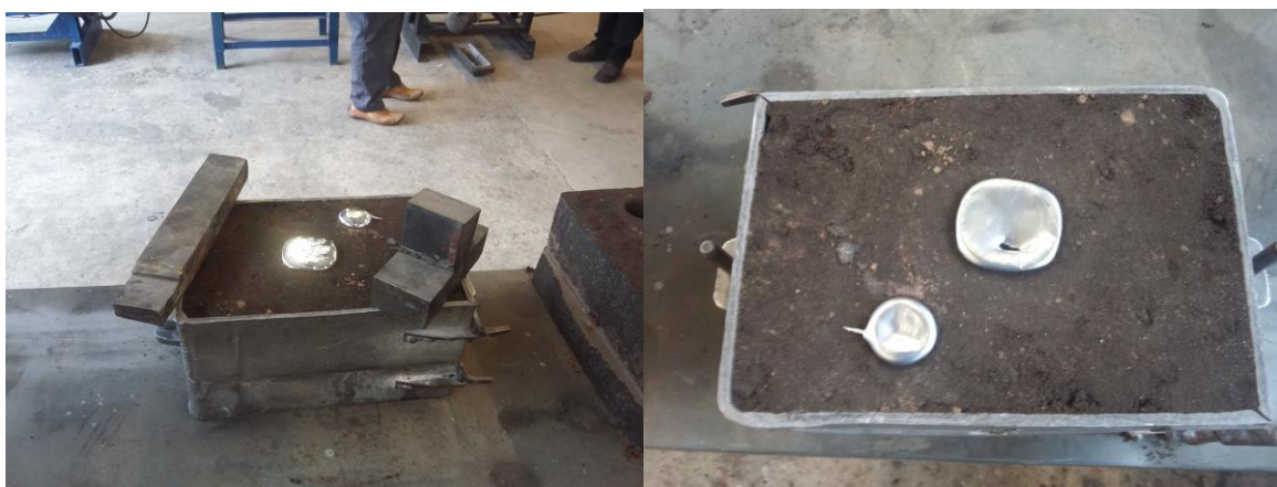
Slika 53. Skrućivanje metala u kalupu
