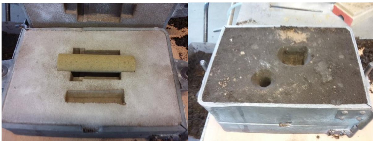
Slika 48. Umetanje jezgre u donjak i sklapanje kalupa
