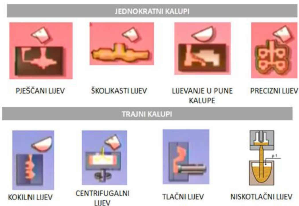
Slika 2. Podjela jednokratnih i trajnih kalupa [1]
