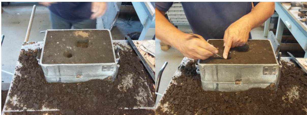
Slika 43. Zaobljenje oštih rubova uljevne čaše i pojila
