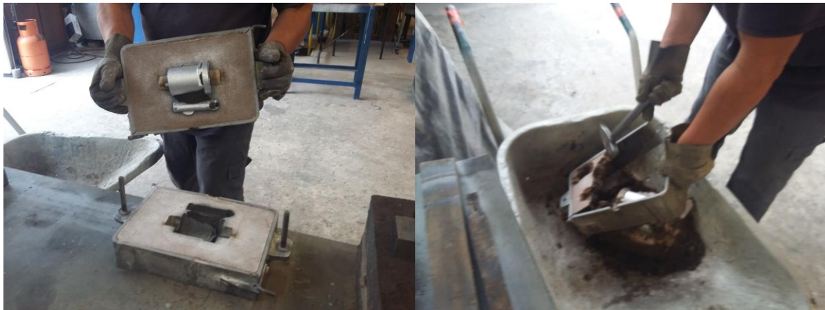
Slika 54. Razdvajanje gornjaka i donjaka te razrušivanje kalupa
