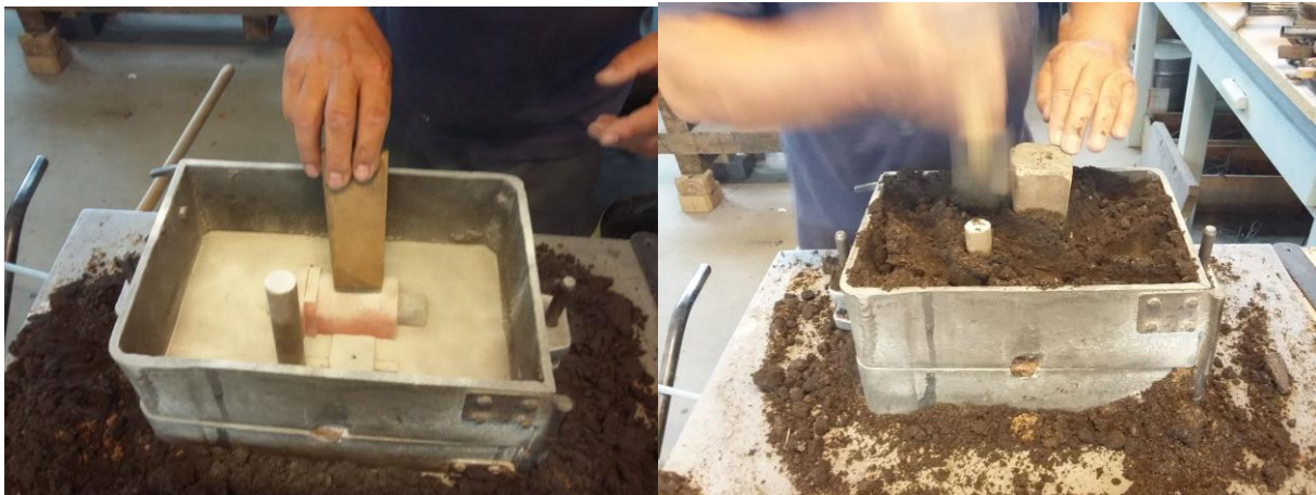
Slika 41. Namješavanje pojila, zasipanje kalupnom mješavinom i sabijanje
