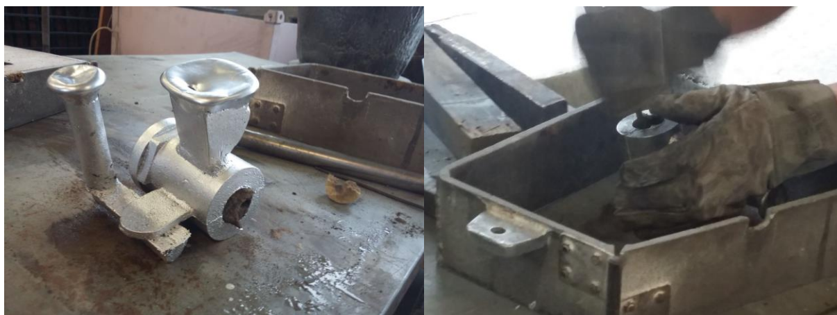
Slika 55. Odljevak izvađen iz kalupa i razrušivanje jezgre
