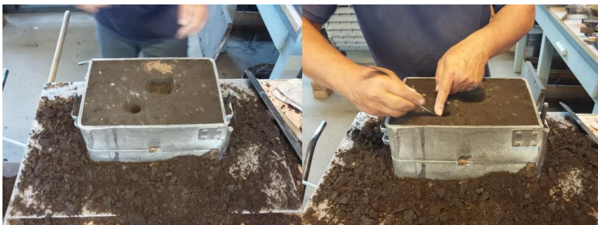
Slika 43. Zaobljenje oštih rubova uljevne čaše i pojila
