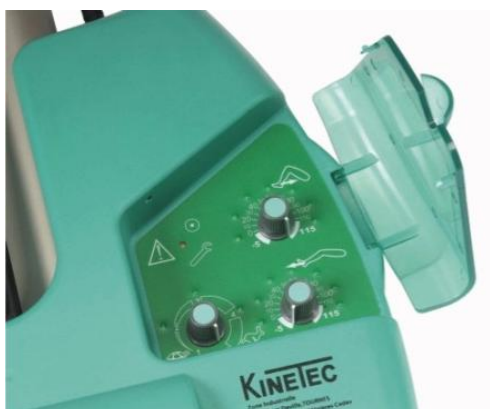
Slika 5. Regulatori brzine i opsega pokreta [13]
