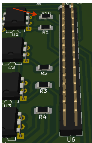
Slika 22. SMD otpornici na pločici (KiCad prikaz)
