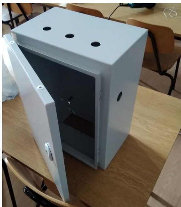
Slika 31. Probušene rupe u razvodnom ormaru
