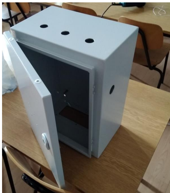
Slika 31. Probušene rupe u razvodnom ormaru
