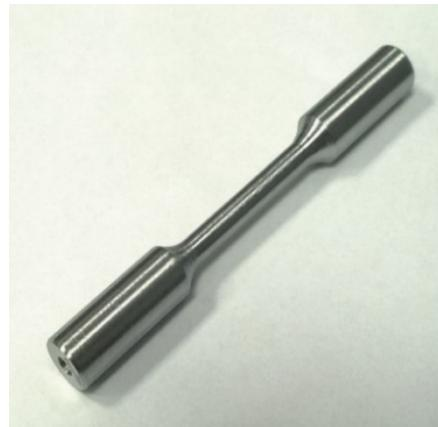
**Slika 15. Epruveta za statičko vlačno ispitivanje [18]**
