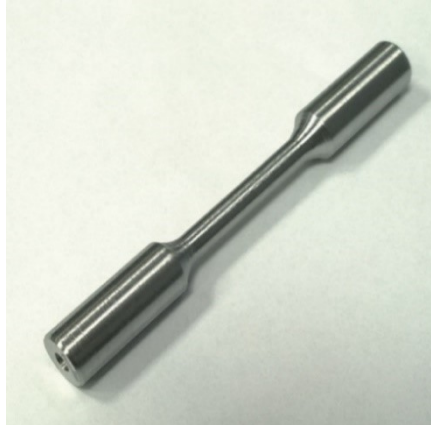
Slika 15. Epruveta za statičko vlačno ispitivanje [18]
