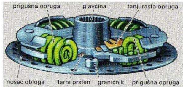
Prigušnik torzijskih vibracija
