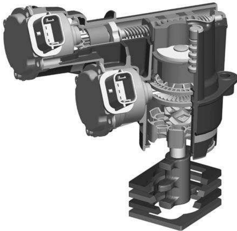
Slika 6.1: Aktuator izmjene stupnjeva prijenosa [4].
