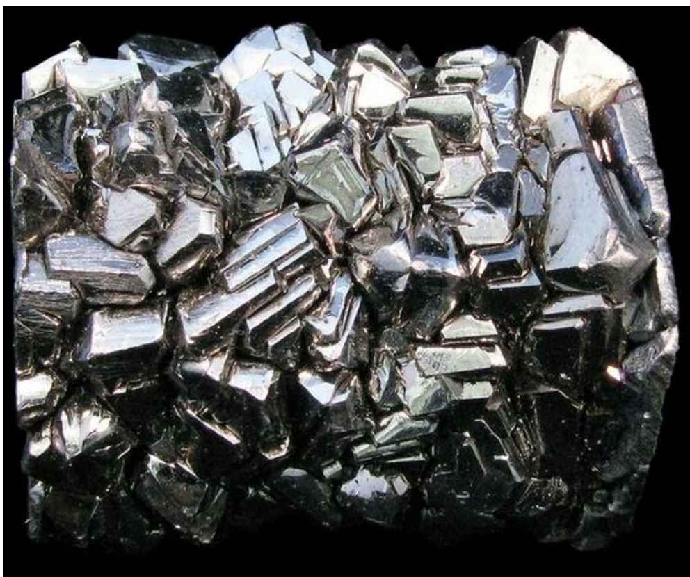
Slika 5. Kristal titanija dobiven van Arkel – de Boer postupkom [8]
