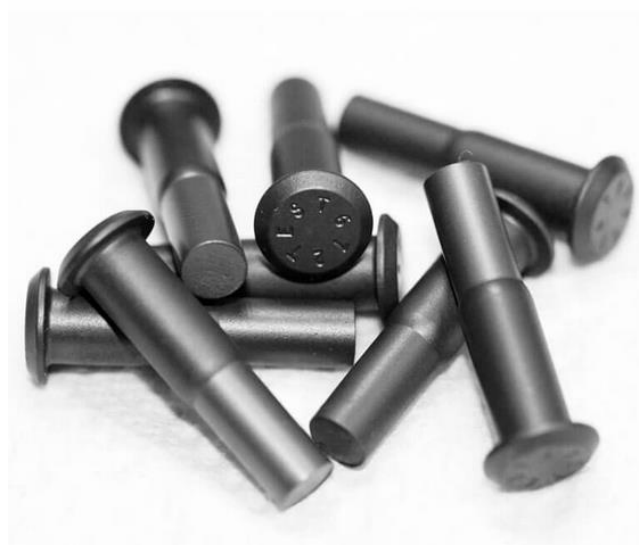
Slika 21. Titanij anodiziran tipom 2 [24]
