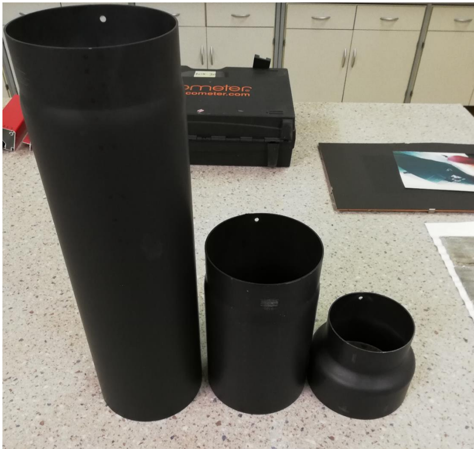
Slika 13. Uzorci sa nanesenim zaštitnim premazom, Laboratorij za zaštitu materijala
