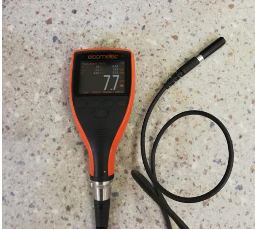
Slika 20. Uređaj za mjerenje debljine premaza „Elcometer 456“
