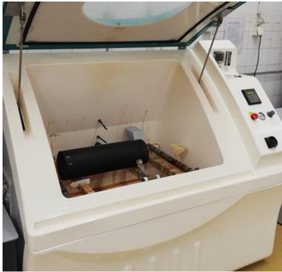
Slika 16. Uzorak broj 3 unutar slane komore, Laboratorij za zaštitu materijala
