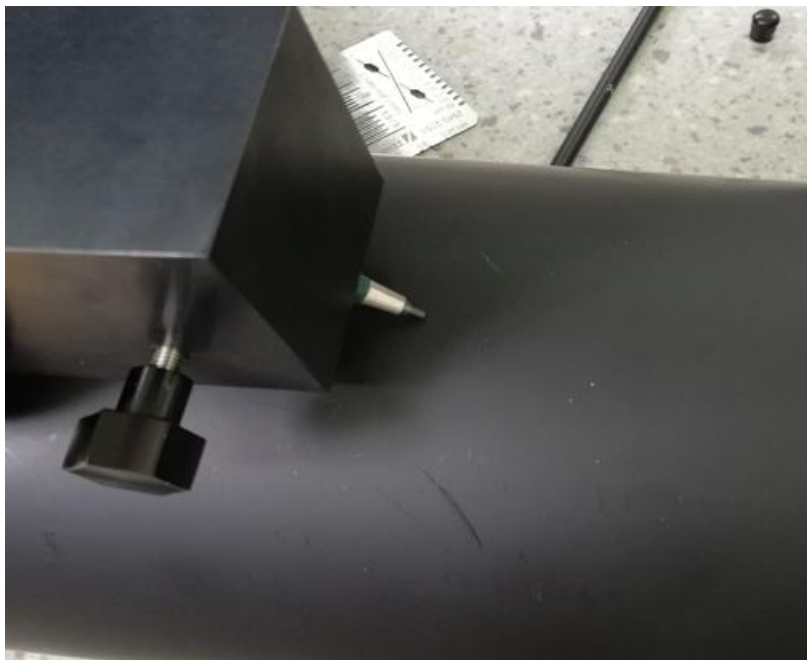
Slika 23. Način provođenja ispitivanja tvrdoće
