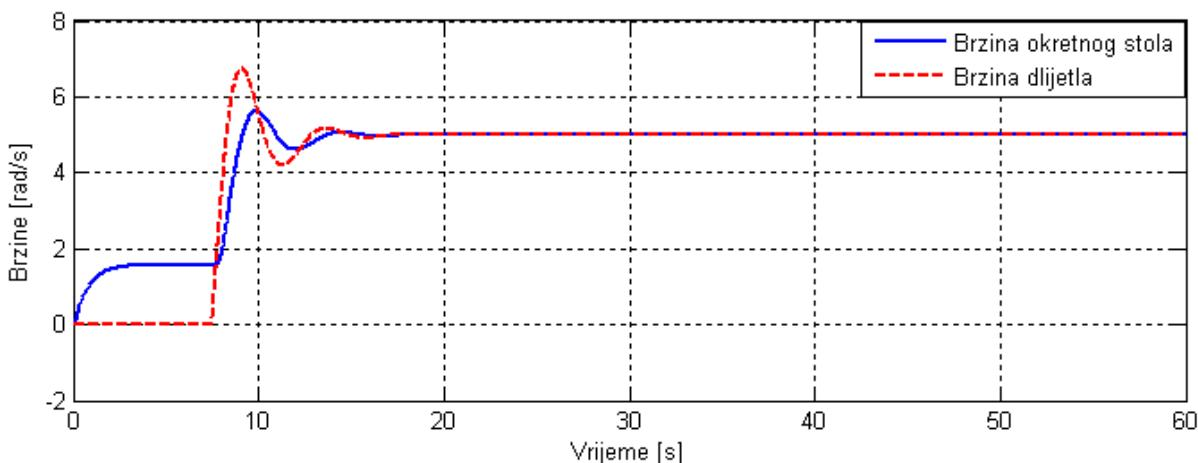
Slika 6.14 Brzina okretnog stola i brzina dlijetla
