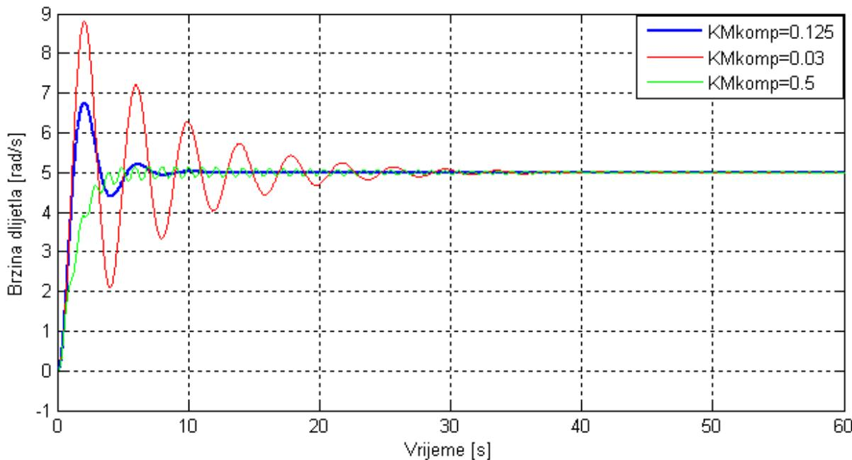
Slika 6.8 Odzivi brzine dlijetla za različite parametre *KM\_komp*
