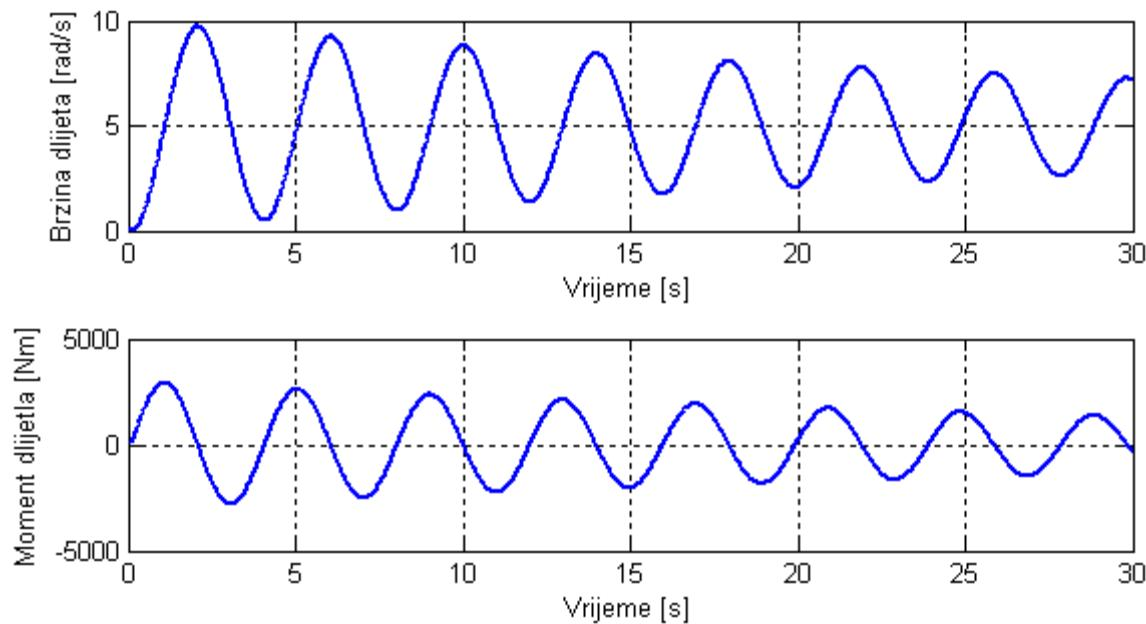
Slika 4.12 Odziv brzine dlijetla i momenta dlijetla
