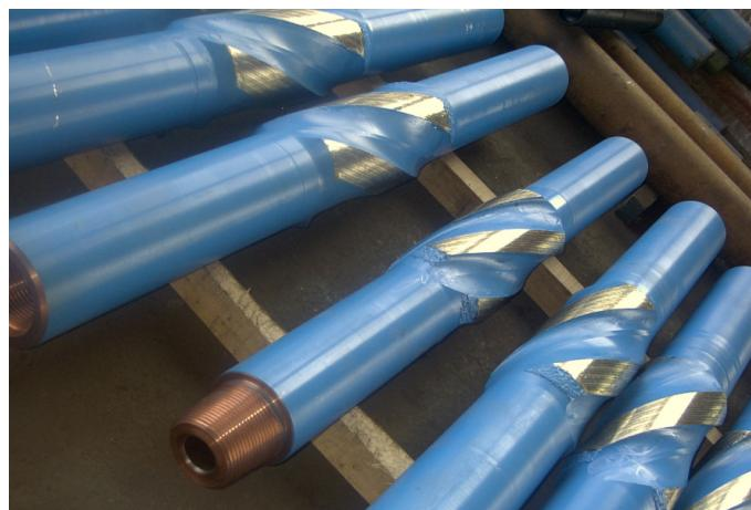
Slika 2.4 Stabilizator vretena
