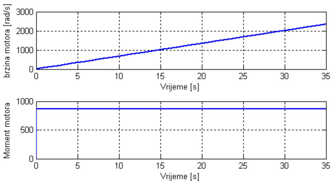
Slika 4.2 Odziv brzine motora na pobudu motora
