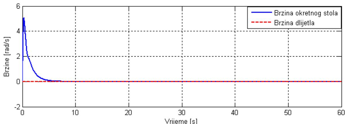
Slika 6.7 Brzina okretnog stola i brzina dlijetla
