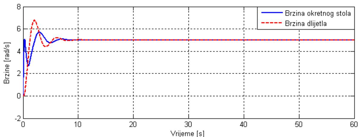
Slika 6.4 Brzina okretnog stola i brzina dlijetla
