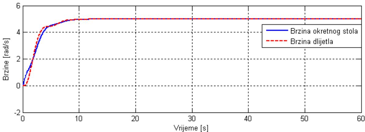
Slika 6.11 Brzina okretnog stola i brzina dlijetla
