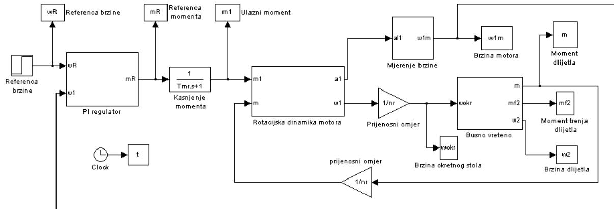
Slika 4.7 Simulacijski model sustava s PI regulatorom
