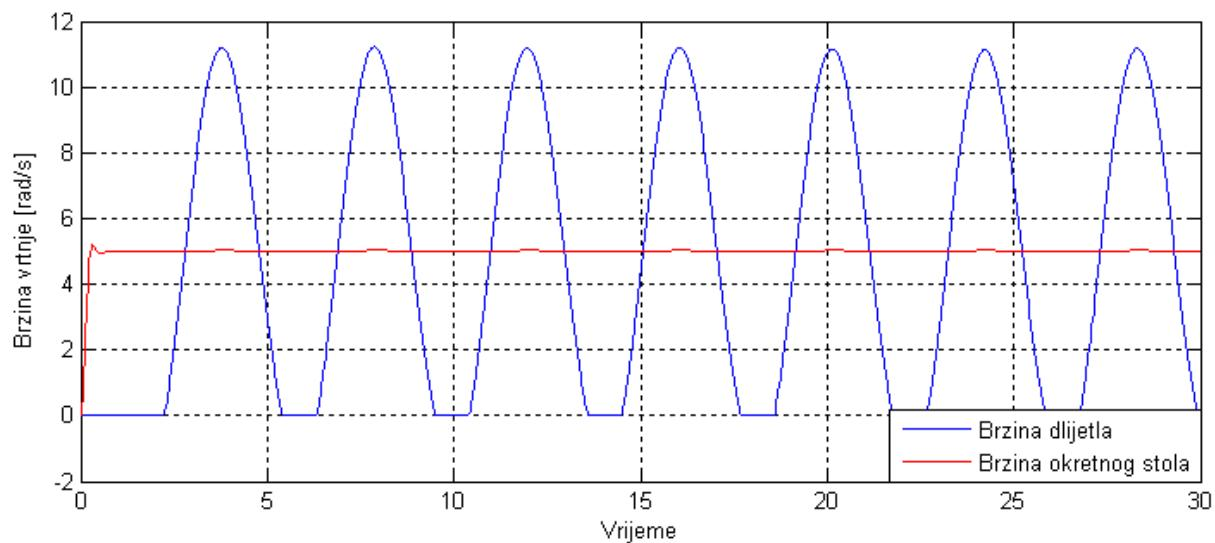
Slika 4.16 Brzina okretnog stola i brzina dlijetla - usporedba
