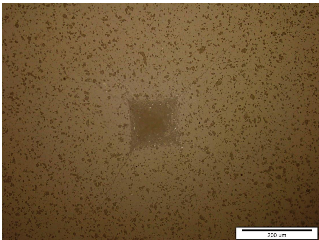
Slika 20. Otisak Vickersovog indentora na uzorku 1
