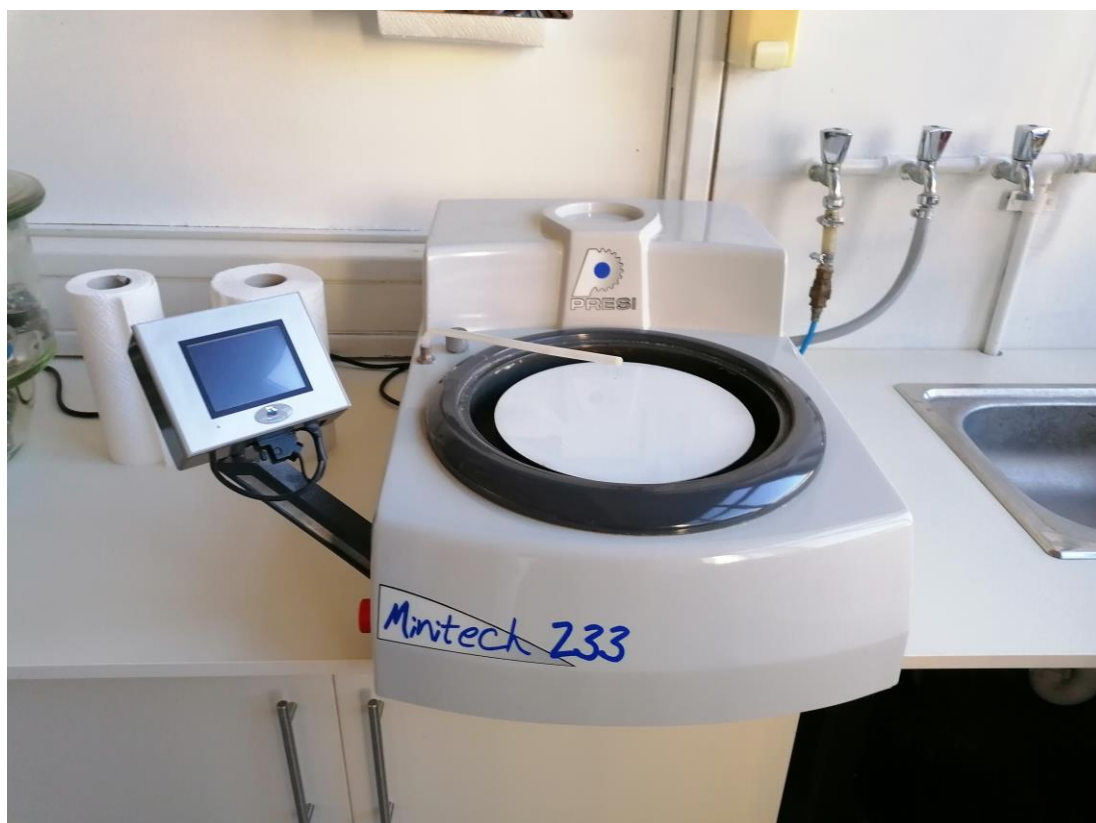
Slika 16. Uređaj za brušenje Minittech 233 - Presi
