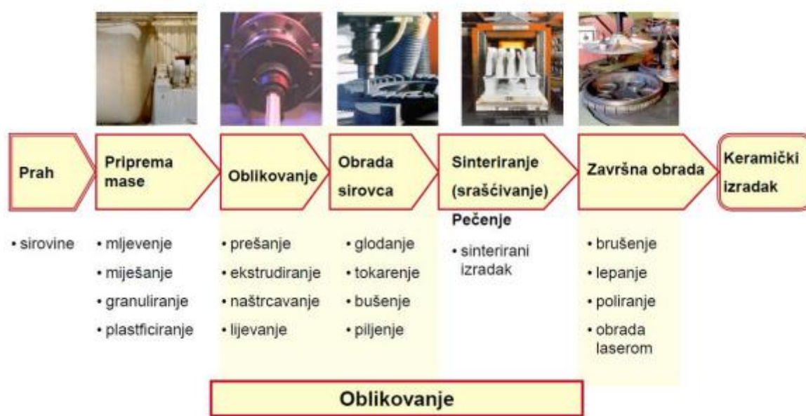
Slika 6. Shematski prikaz proizvodnje keramičkog izratka [7]
