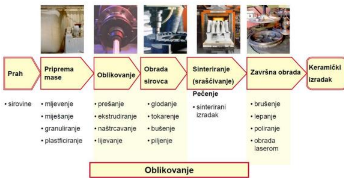
Slika 6. Shematski prikaz proizvodnje keramičkog izratka [7]
