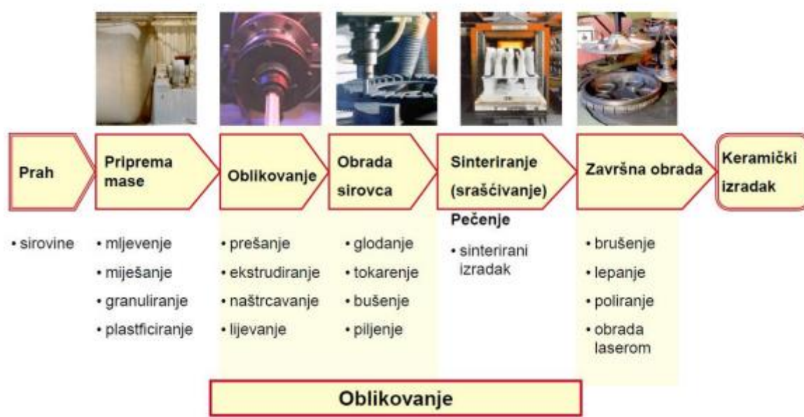
Slika 6. Shematski prikaz proizvodnje keramičkog izratka [7]
