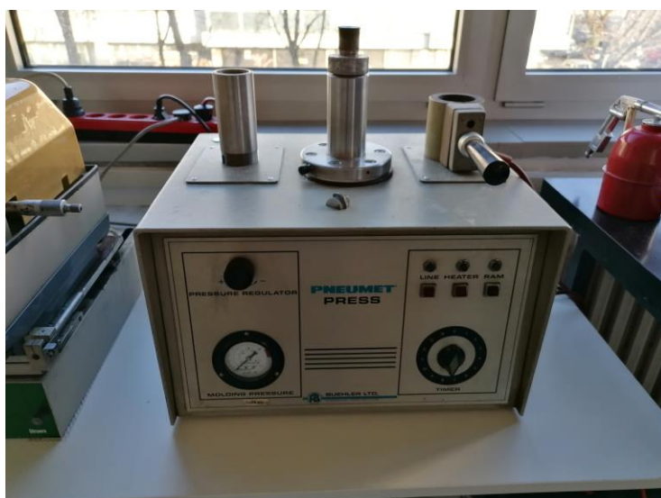
Slika 15. Uređaj za vruće zalijevanje uzoraka Buehler LTD. Pneumet Press
