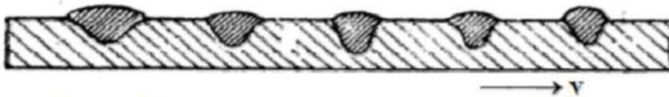
Slika 6. Utjecaj brzine zavarivanja na geometriju zavara [8]
