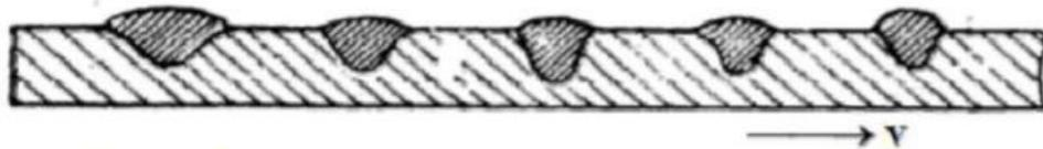
Slika 6. Utjecaj brzine zavarivanja na geometriju zavara [8]
