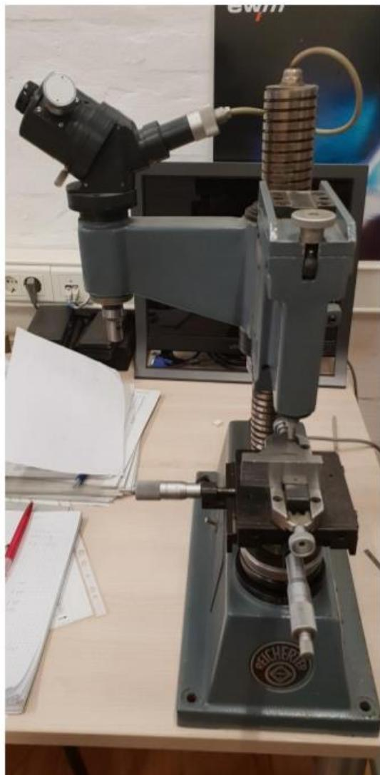
Slika 28. Tvrdomjer Reicherter TM12 [5]
