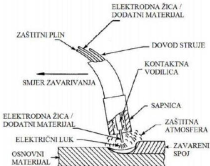
Slika 4. Prikaz završnog dijela pištolja za MAG zavarivanje [5]
