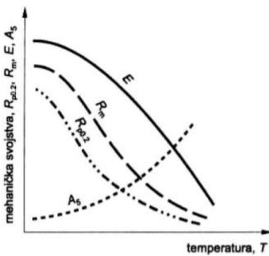
Slika 11. Promjena mehaničkih svojstava s povišenjem temperature [12]
