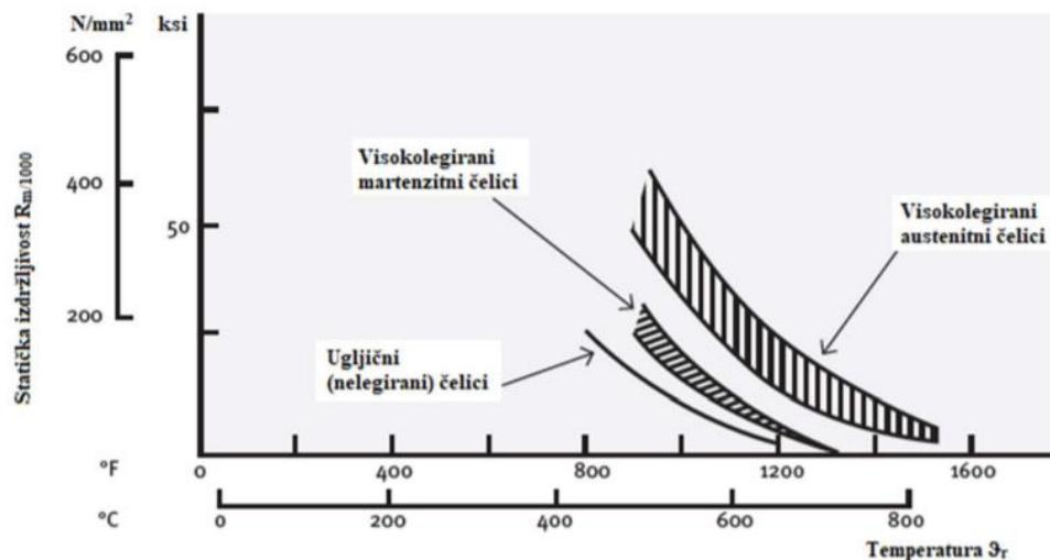
Slika 10. Prikaz ovisnosti statičke izdržljivosti o radnoj temperaturi [13]
