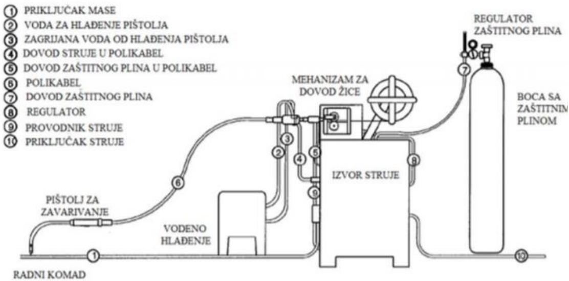
Slika 3. Prikaz opreme za MAG zavarivanje [5]
