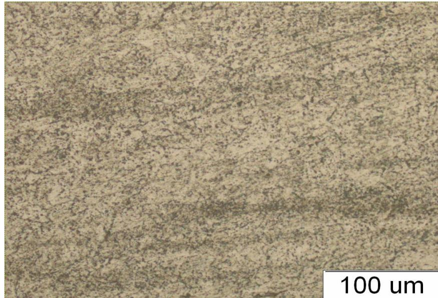
Slika 25. Prikaz mikrostrukture osnovnog materijala
