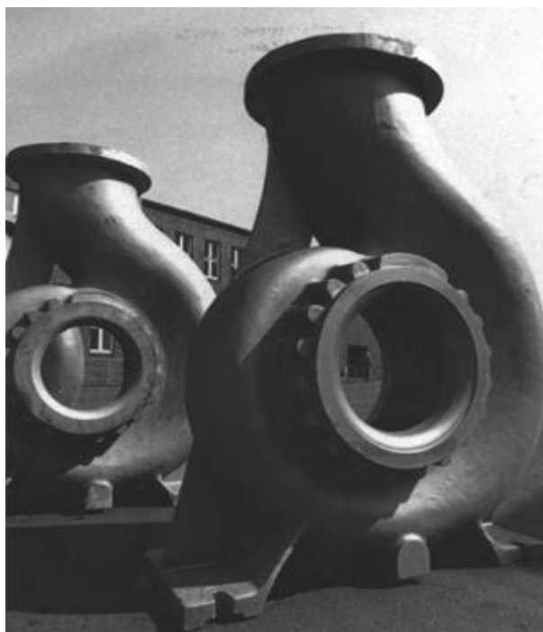
Slika 1. Kućišta pumpi izlivena iz dupleks nehrđajućeg lijeva GX2CrNiMoCuN 26-6-3-3 [3]
