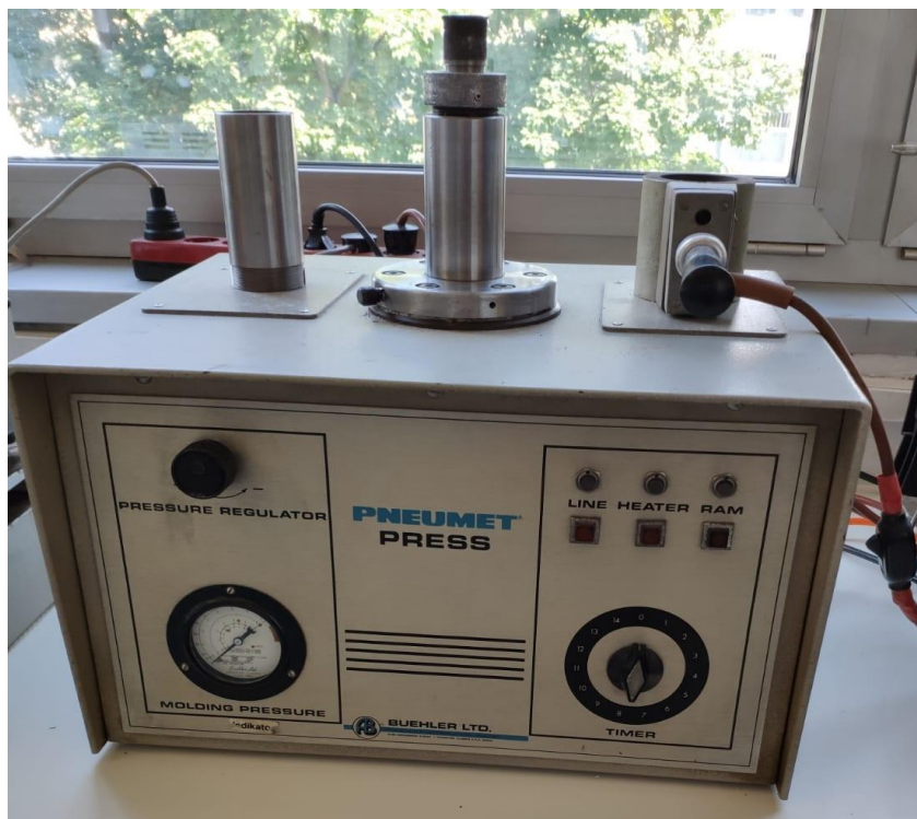
Slika 25. Preša za zalijevanje uzoraka
