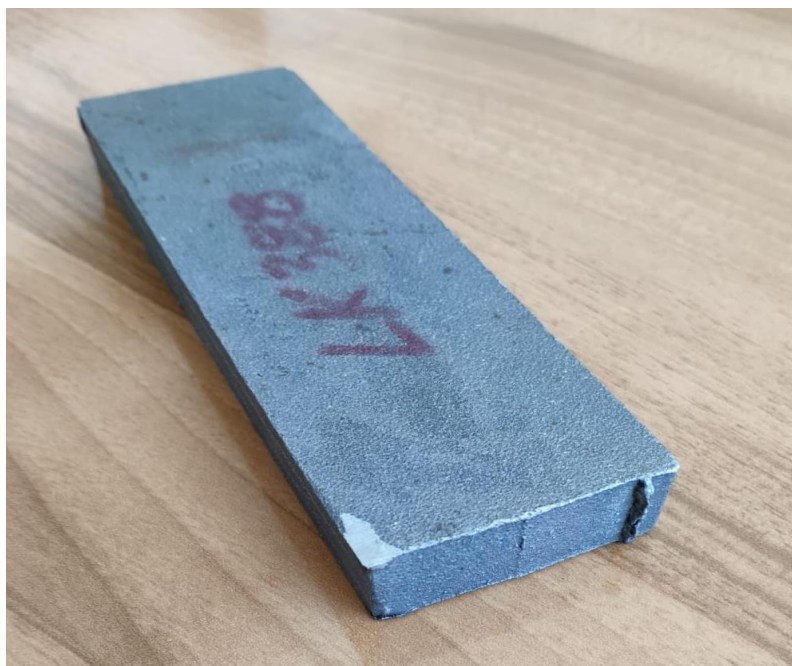
Slika 19. Odljevak dupleks nehrđajućeg čeličnog lijeva iz kojeg su izrezani uzorci za ispitivanje
