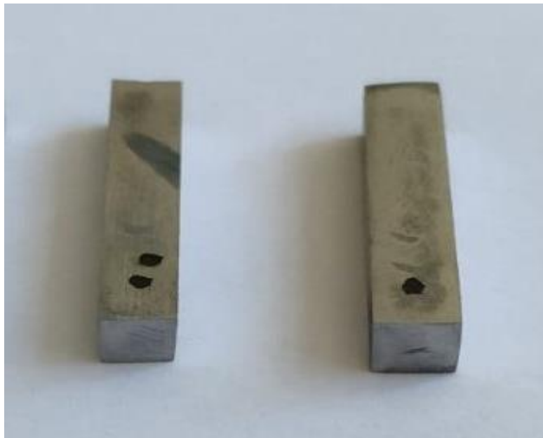
Slika 20. Izrezani uzorci za ispitivanje otpornosti na abrazijsko trošenje
