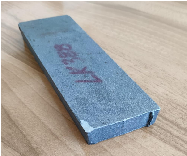
Slika 19. Odljevak dupleks nehrđajućeg čeličnog lijeva iz kojeg su izrezani uzorci za ispitivanje
