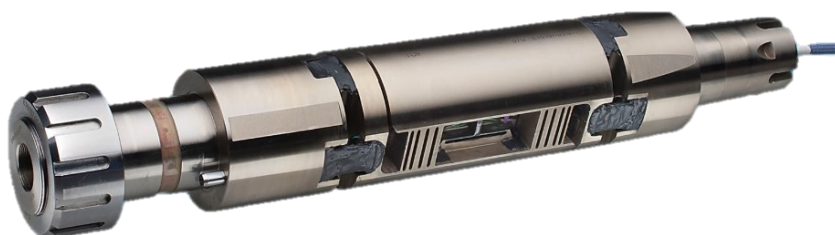
Slika 7. Monolitna unutarnja vaga opremljena tenzometarskim trakama [8]
