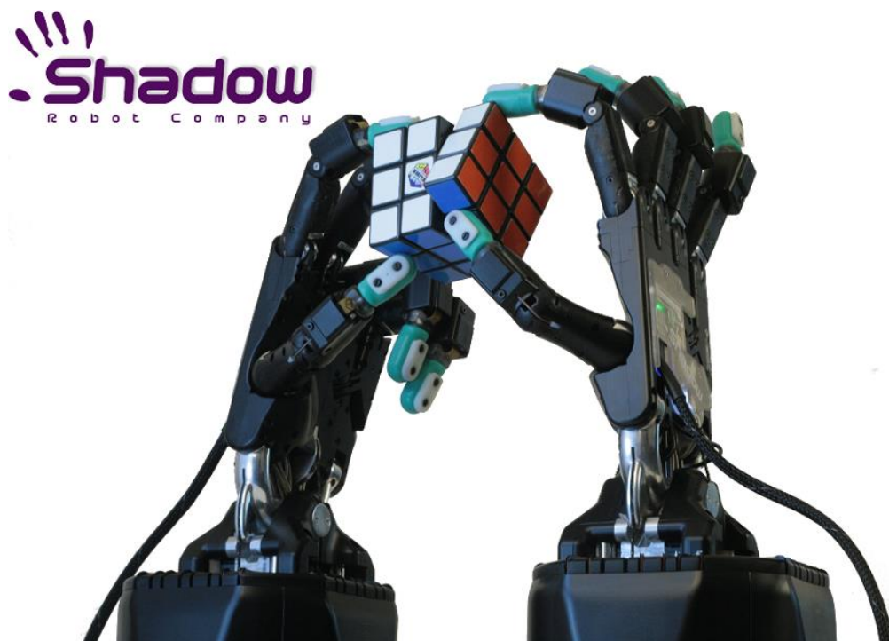
Slika 16. Humanoidna robotska ruka The Shadow Hand [12]
