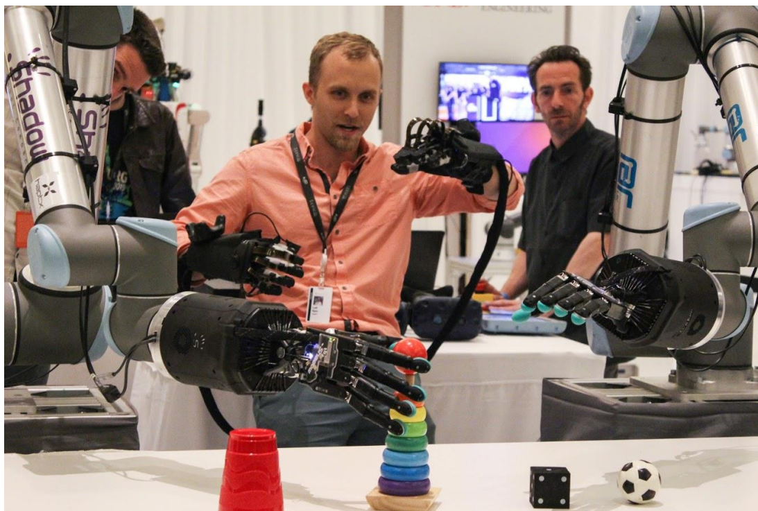
Slika 17. Teleoperacija robota podatkovnim rukavicama [15]
