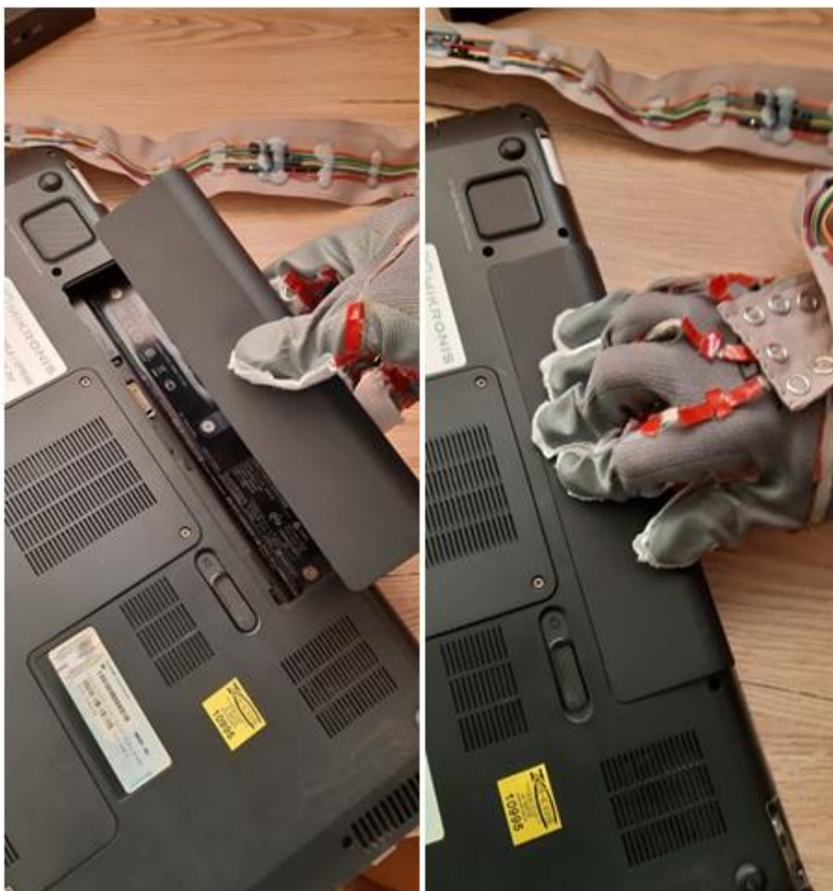
Slika 37. Montaža baterije u prijenosno računalo
