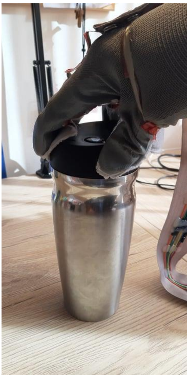
Slika 34. Hvatanje poklopca termos-boce prilikom njegovog uvrtnanja i odvrtnanja
