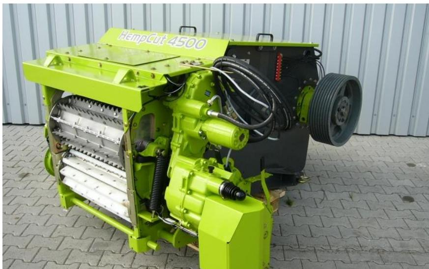
**Slika 32. Agregat i jedinica za usitnjavanje stabljike**
