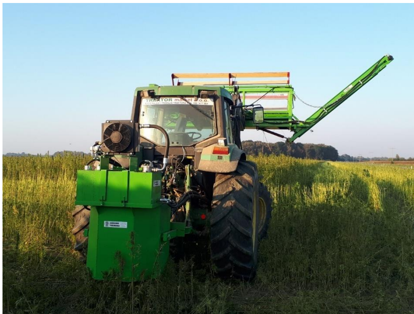
Slika 22. Stražnji podsustav sastavljen od hidrauličkih komponenti i protuutega
