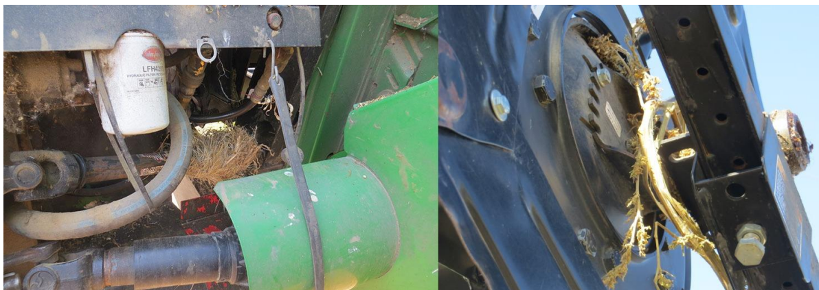
Slika 10. Zaplitanje oko kardanskog vratila žetvenog uređaja i motovila
