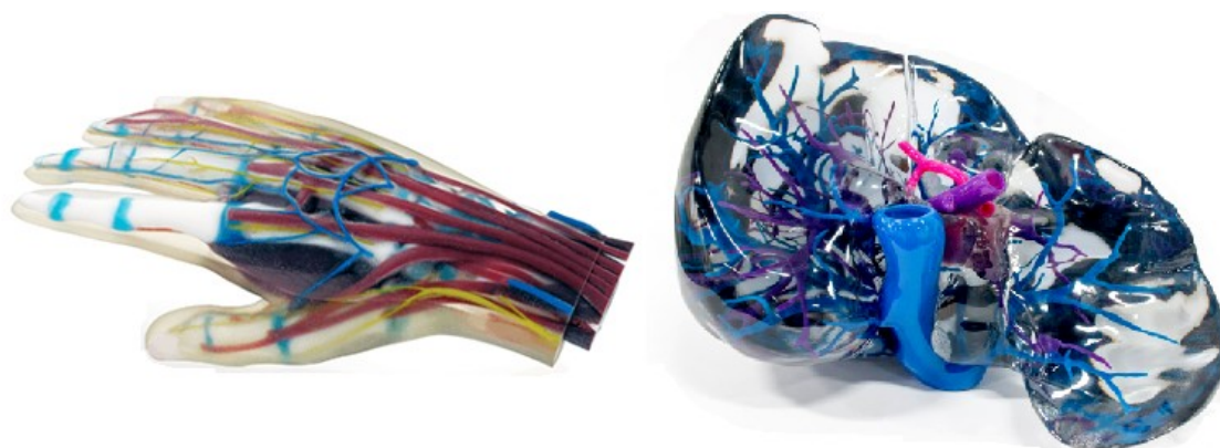
Slika 3. Modeli isprintani postupkom PolyJet [9][10]
