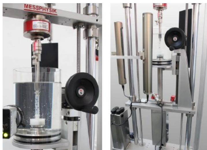
Slika5. Uređaj za test tlak – istezanje[16]
