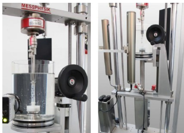
Slika5. Uređaj za test tlak – istezanje[16]
