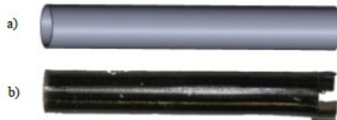
Slika 6. a) CAD model uzorak, b) ispisan model[16]
