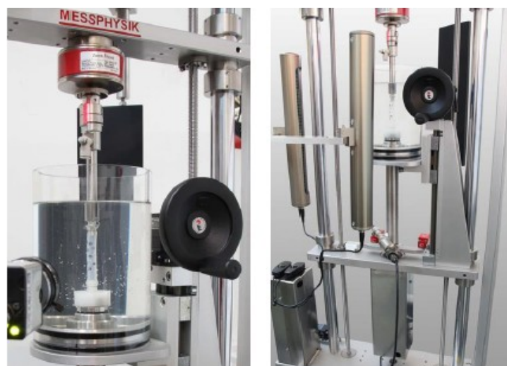
Slika5. Uređaj za test tlak – istezanje[16]
