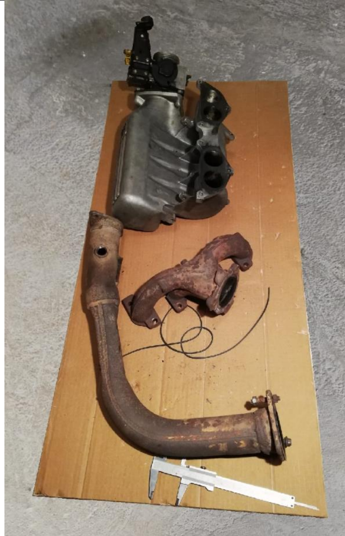
Slika 2.1. Dijelovi usisnog i ispušnog sustava
