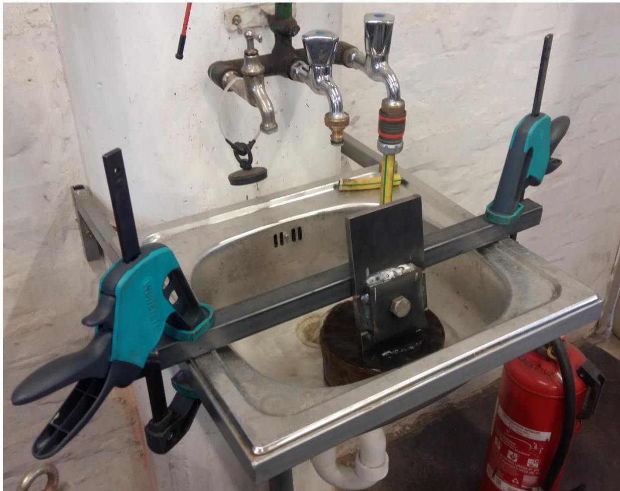
Slika 39. Hlađenje sklopa nakon nanošenja prvog ispitnog zavara
