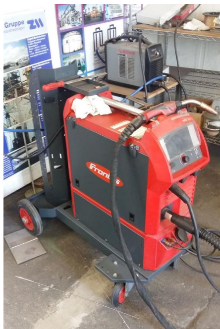
Slika 35. Uređaj za zavaivanje Fronius TPS 320i
