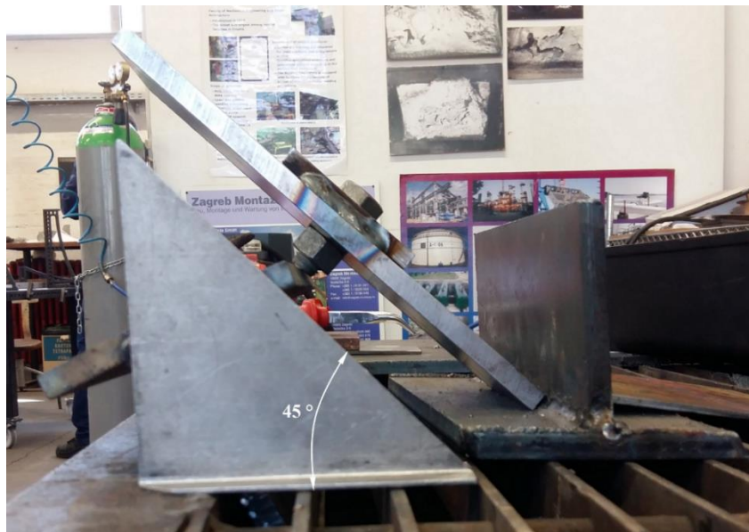
Slika 38. Položaj ploče za nanošenje prvog ispitnog zavora
