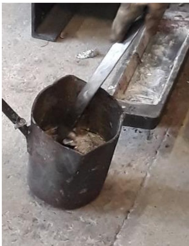
Slika 49. Čišćenje aluminijskih oksida sa površine taljevine.
