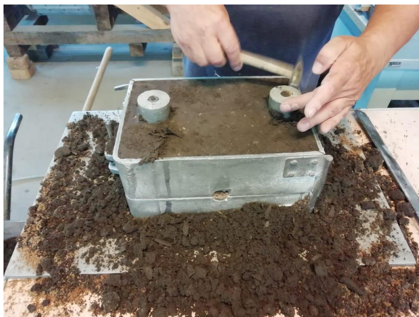
Slika 43. Postupak vađenja pojila i spusta iz gornjaka.
