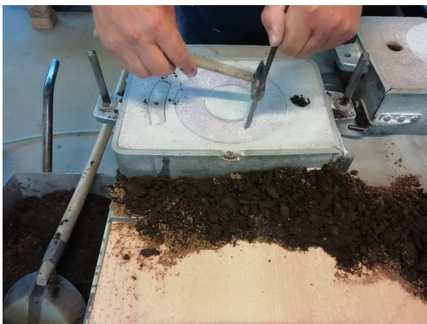
Slika 44. Vađenje modlea i razvodnika iz donjaka.
