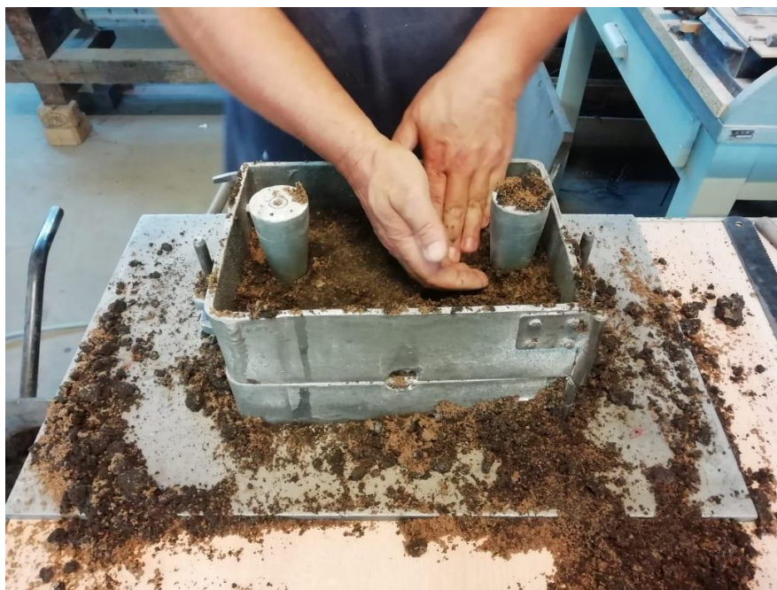
Slika 41. Stavljanje modelne kalupne mješavine u gornjak.
