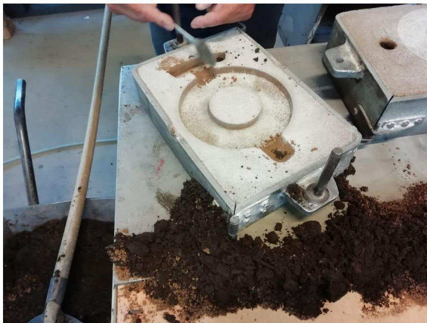
Slika 45. Postupak oblikovanja ušća i vrata pojila pomoću lancete.
