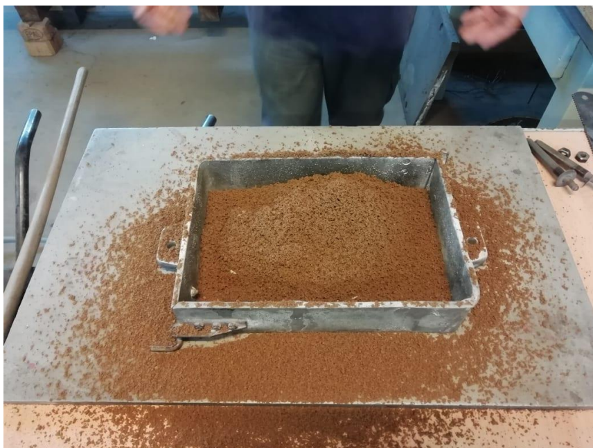
Slika 37. Stavljanje modelne kalupne mješavine u donjak.
