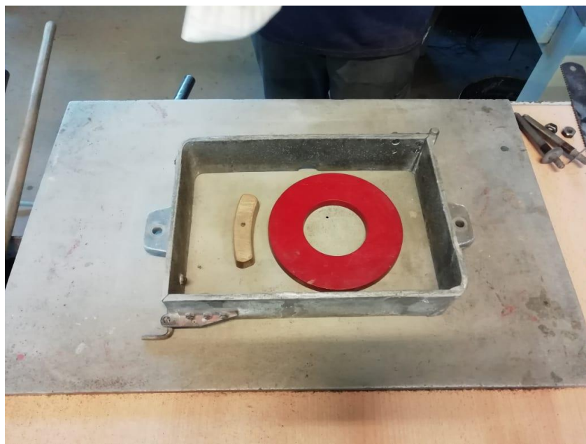
Slika 35. Pozicija diska i razvodnika u donjaku.
