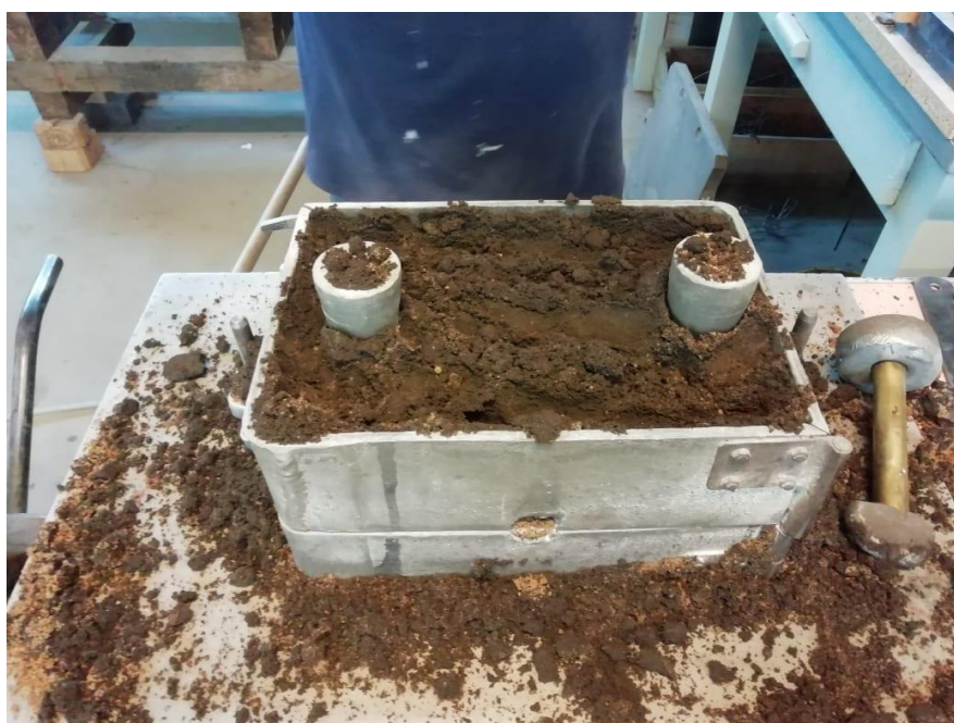
Slika 42. Stavljanje punidbene kalupne mješavine u gornjak.
