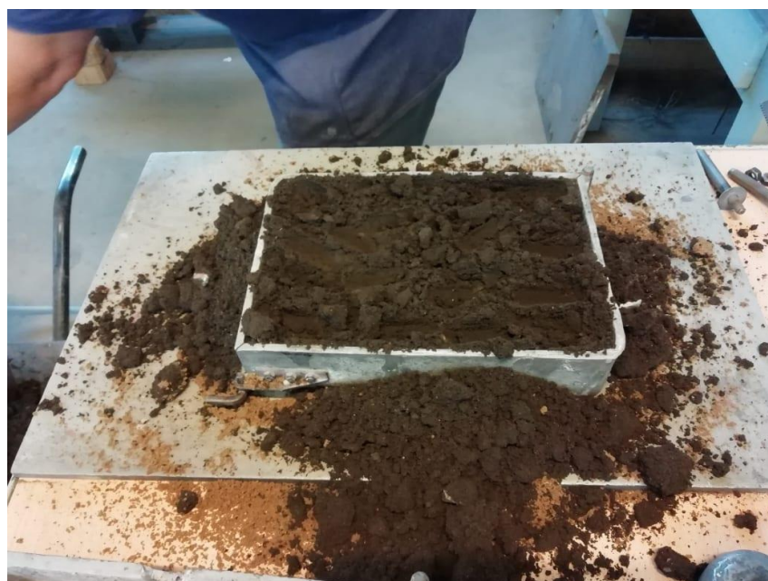
Slika 38. Stavljanje punidbene kalupne mješavine u donjak.
