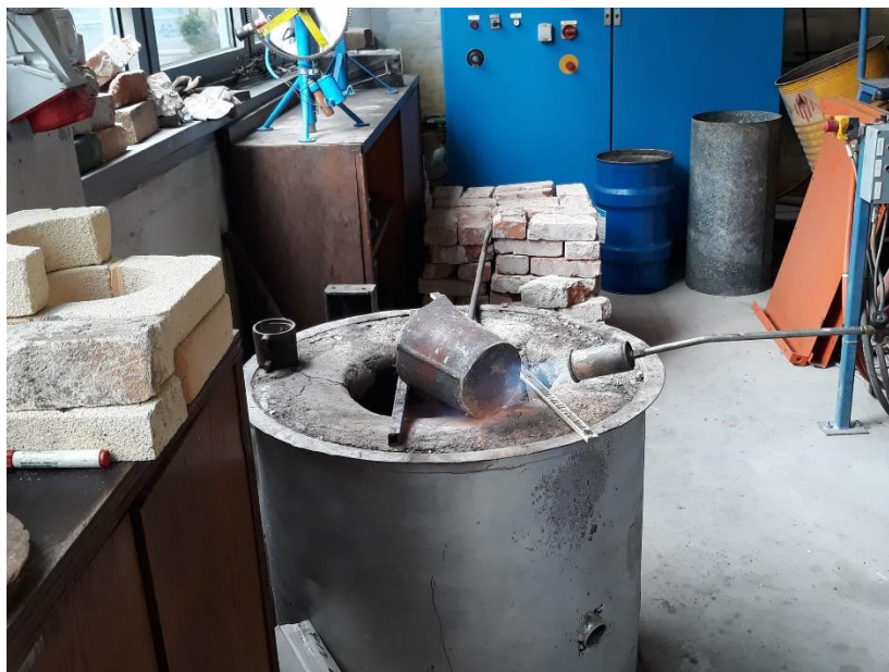
Slika 46. Zagrijavanje lonca za lijevanje taljevine.
