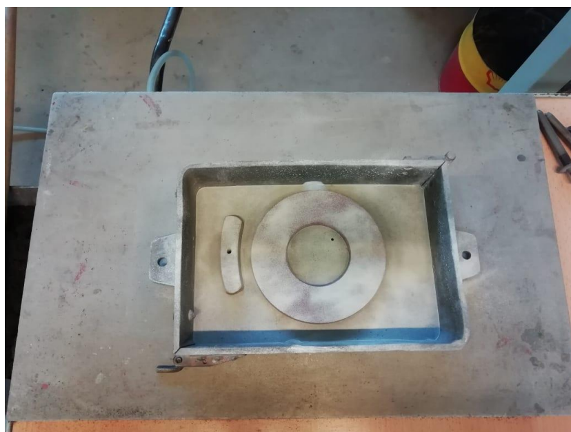
Slika 36. Sredstvo za razdvajanje stavljeno na model i razvodnik.
