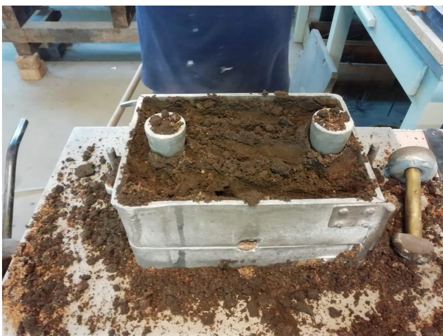
Slika 42. Stavljanje punidbene kalupne mješavine u gornjak.
