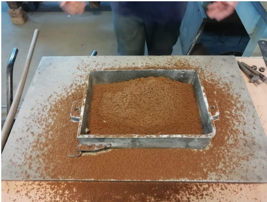
Slika 37. Stavljanje modelne kalupne mješavine u donjak.
