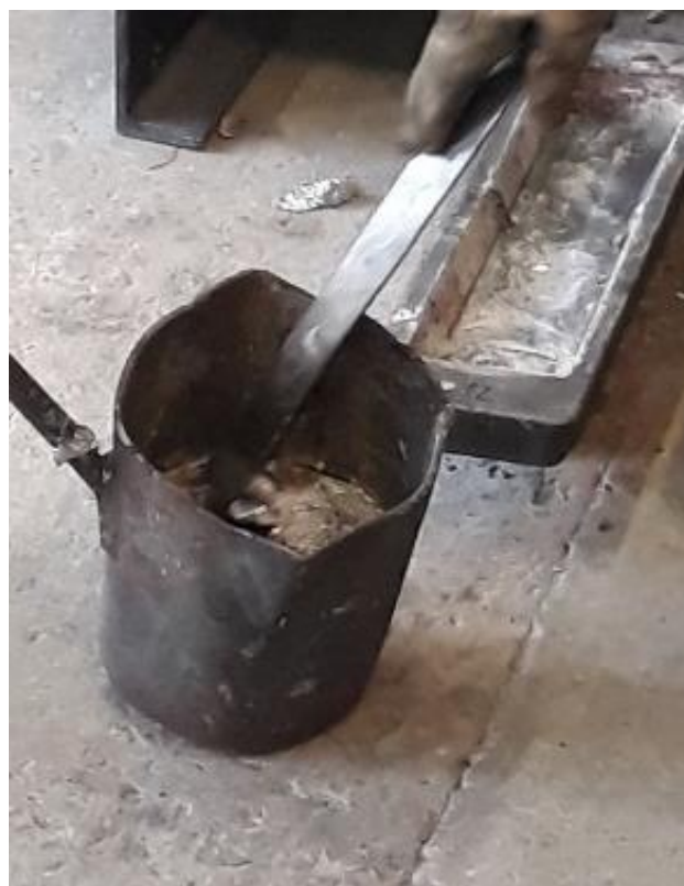
Slika 49. Čišćenje aluminijskih oksida sa površine taljevine.
