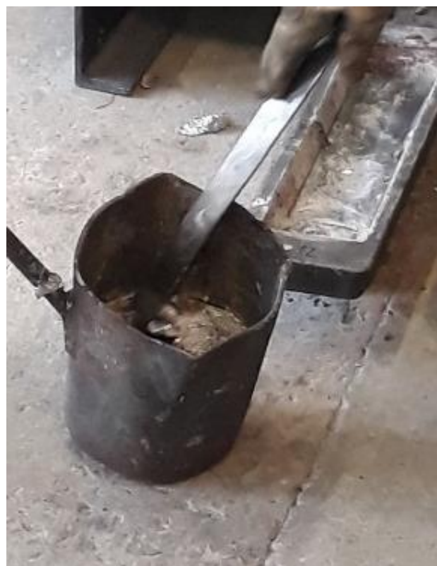
Slika 49. Čišćenje aluminijskih oksida sa površine taljevine.
