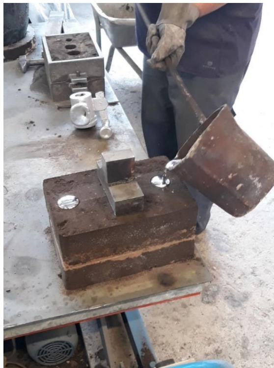
Slika 50. Ulijevanje taljevine u kalup.
