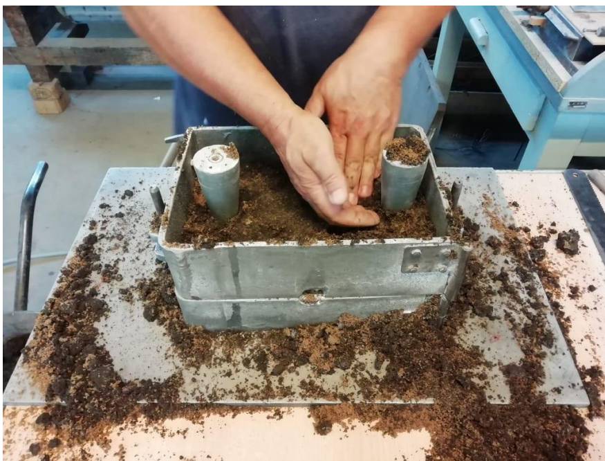
Slika 41. Stavljanje modelne kalupne mješavine u gornjak.
