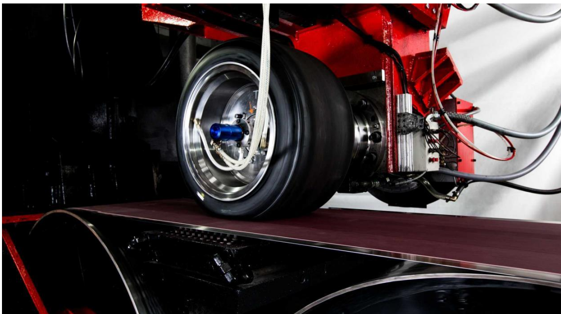
Slika 96. Ispitivanje pneumatika na Calspan ispitnom postavu, [2]
