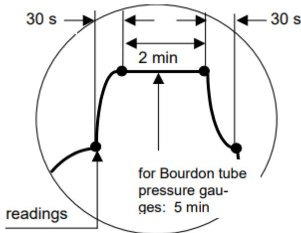
**Slika 4. Smjernice za pravilno očitanje**
