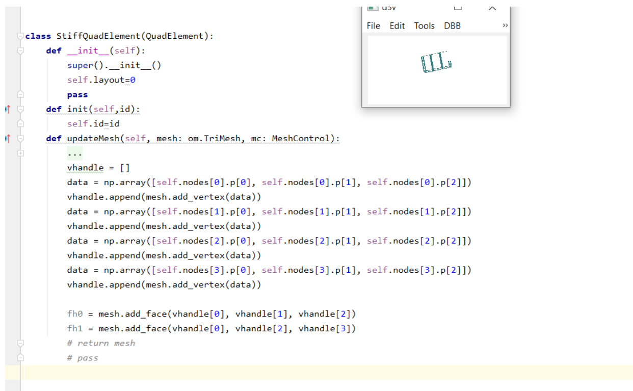
Slika 13. Programski kod vizualizacije grednog elementa s T poprečnim prejemom
