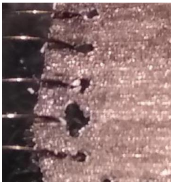
Slika 8. Pucanje uzorka uslijed koncentracije naprezanja
