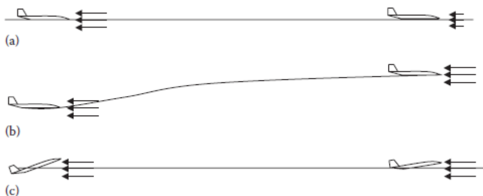
Slika 6. Tri opcije za konstantan pad uzgona tijekom krstarenja ( a) pad brzine leta, b) rast visine leta, c) pad napadnog kuta ) [1]
