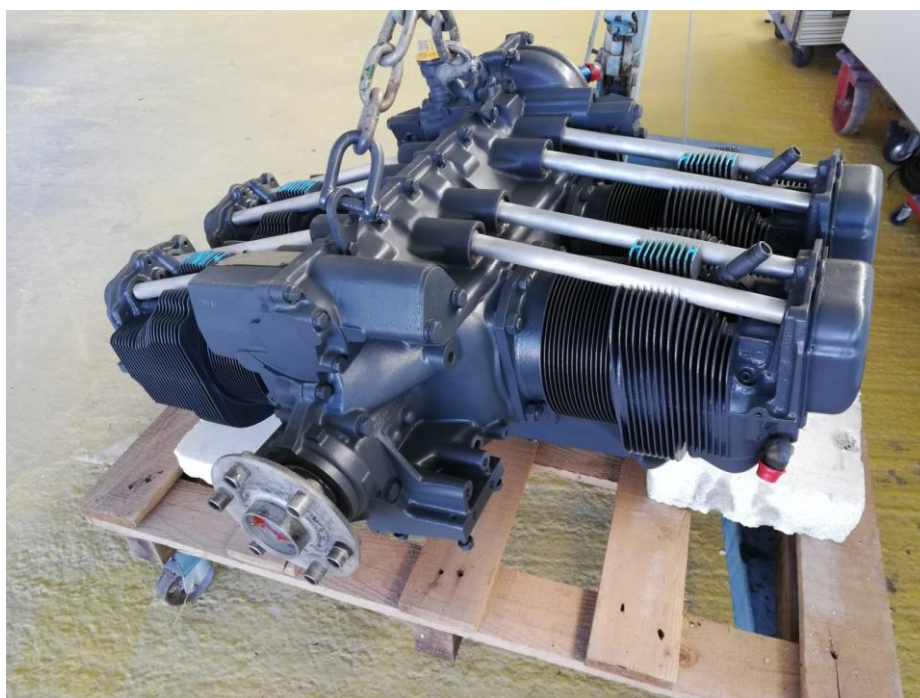
Slika 2.3. Motor zrakoplova Cessna 172N Skyhawk Lycoming O-320-H2AD (Izvor: iz vlastitog albuma)
