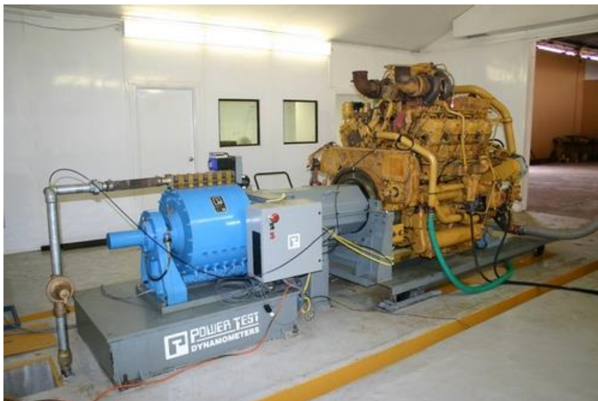
Slika 2.9. Motor priključen na mjernu kočnicu [13]
