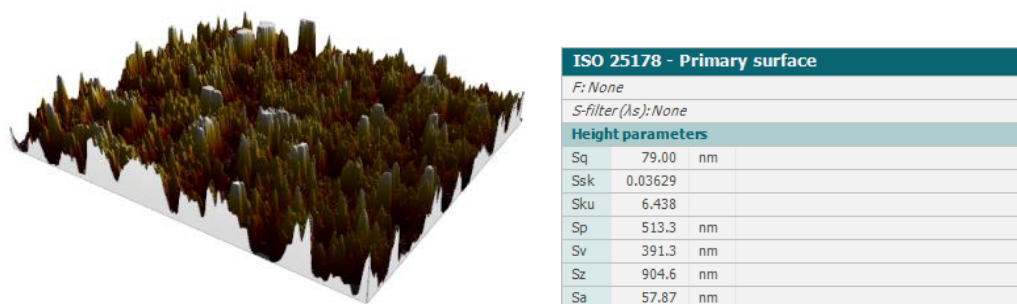
Slika 26. Uzorak 1 – 3D prikazi i 3D parametri topografije
