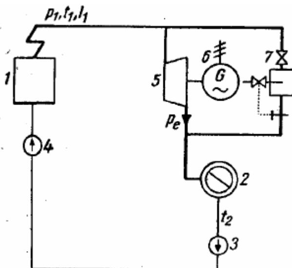
Slika 6. Shema kogeneracijskog postrojenja s protutlačnom turbinom[11]
