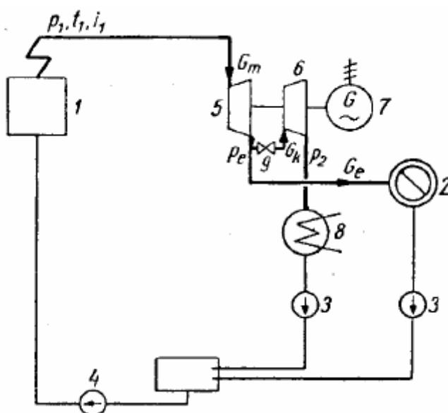
Slika 7. Shema kogeneracijskog postrojenja s reguliranim oduzimanjem pare[11]
