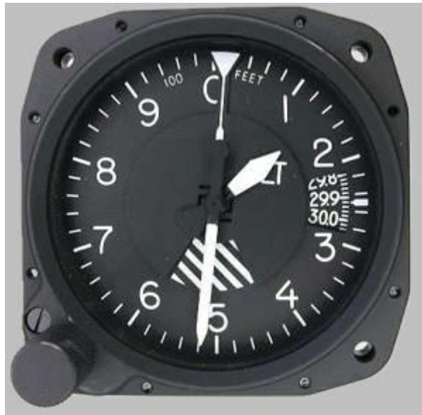
Slika 2.1. Barometarski visinomjer sa podjelom u stopama (feet)
