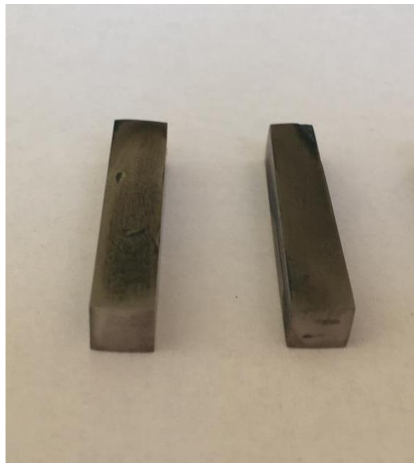
Slika 19. Izrezani uzorci iz odljevka lijeva oznake GX5CrNi 19-10
