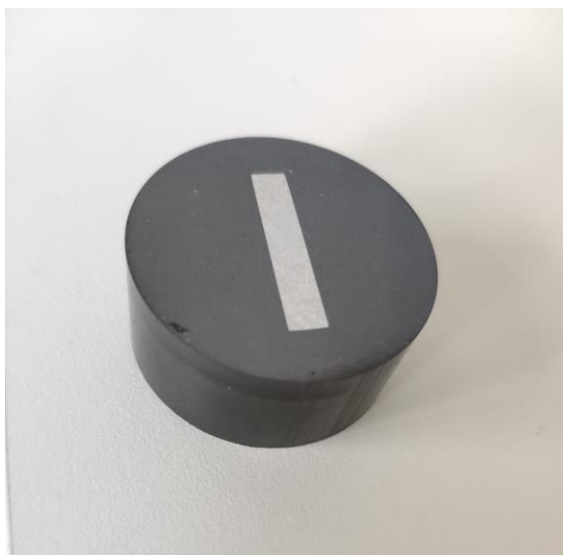
Slika 25. Pripremljen uzorak za ispitivanje mikrostrukture
