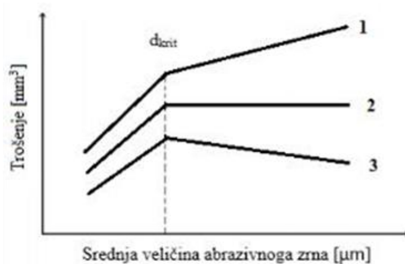
Slika 17. Utjecaj veličine zrna na intenzitet abrazijskog trošenja [7]
