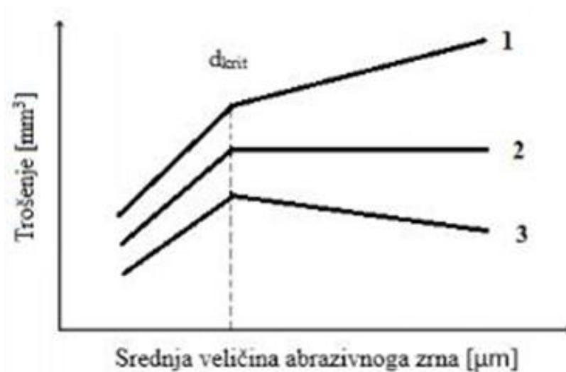
Slika 17. Utjecaj veličine zrna na intenzitet abrazijskog trošenja [7]
