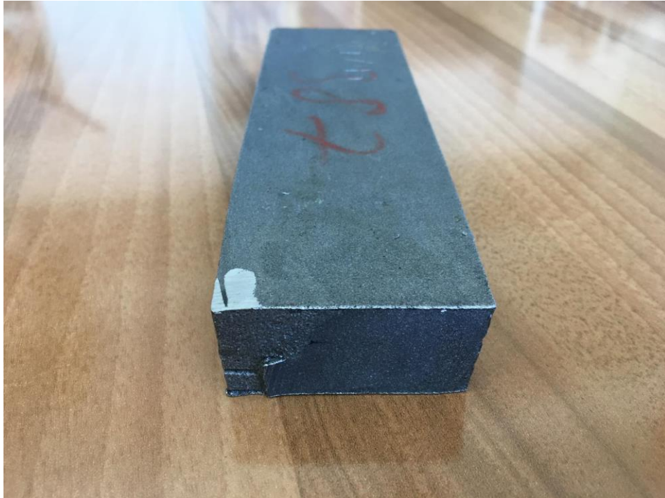
Slika 18. Odljevak lijeva oznake GX5CrNi 19-10
