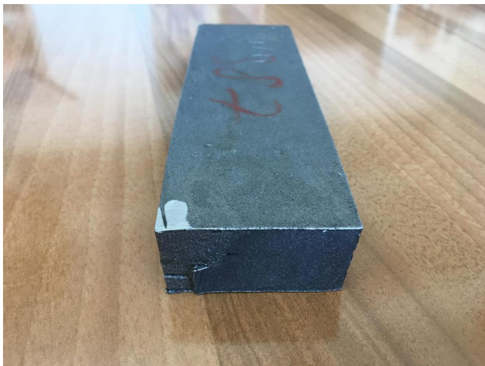
Slika 18. Odljevak lijeva oznake GX5CrNi 19-10
