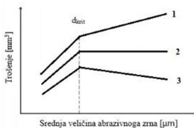
Slika 17. Utjecaj veličine zrna na intenzitet abrazijskog trošenja [7]
